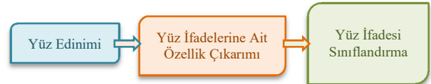
Şekil 1. Yüz ifade analizi sisteminin temel yapısı (Basic structure of facial expression analysis)
