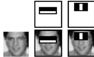
Şekil 3. Dikdörtgen özelliklerin yüz görüntülerine uygulanması (Implementation of the rectangular features on facial images) [51]
