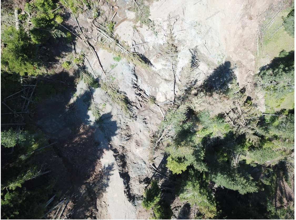
Şekil 3.2. Enine drenaj yapısı inşa edilmeyen kesişim noktası ve kazı şevinde meydana gelen göçme.
