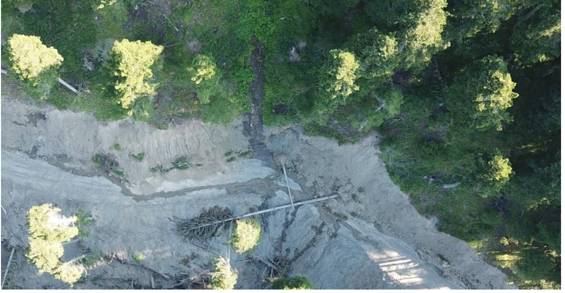
Şekil 3.3. Dere yatağı düzenlenmemiş ve enine drenaj yapısı tesis edilmemiş dere-yol kesişimi ve meydana gelen göçme.
