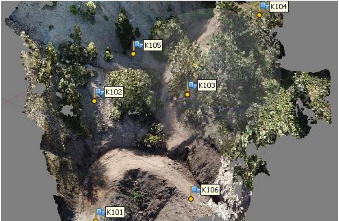
Şekil 2.17. 3B modelin yüksek yoğunlukta yeniden oluşturulması işlem adımı.
