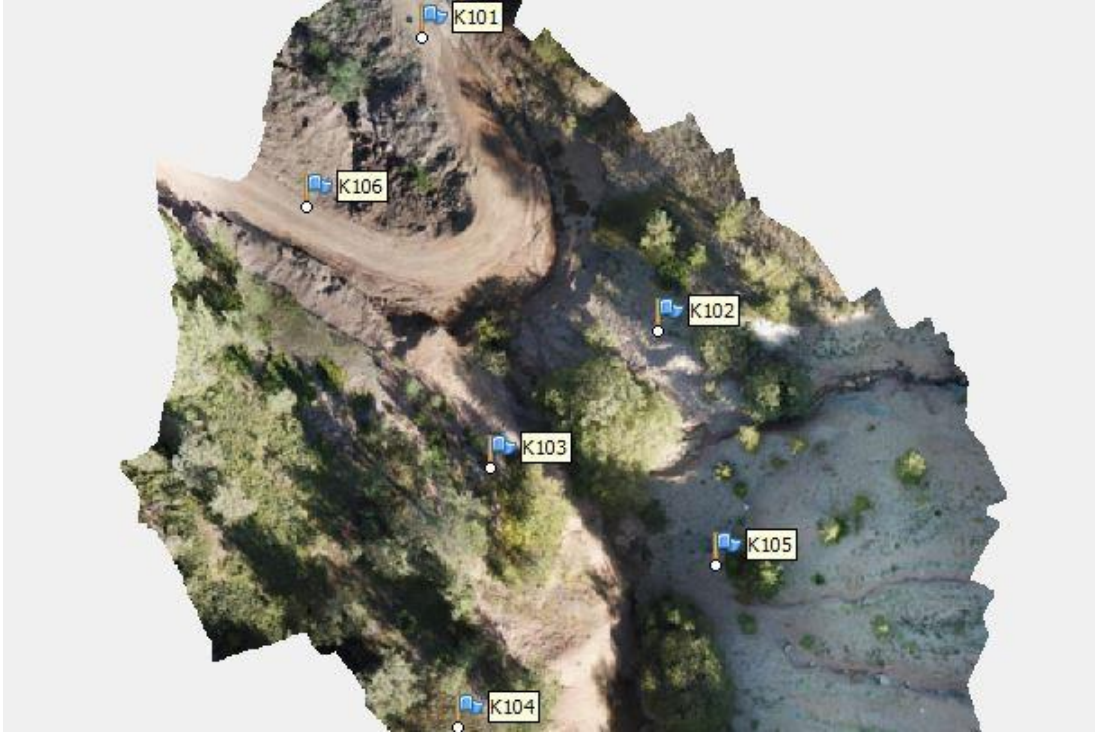
Şekil 2.16. Agisoft Metashape Professional ölçülen YKN lerin eklenmesi ve model doğruluğunun artırılması.
