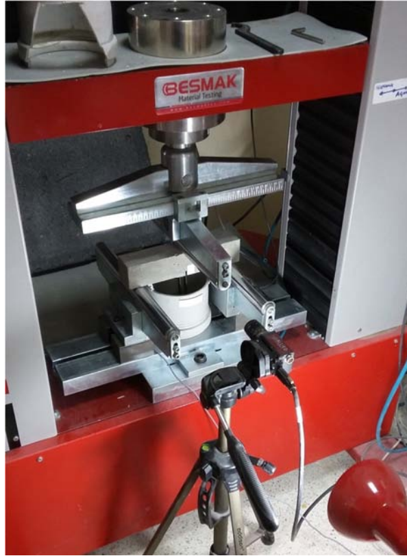
Şekil 3.13. Kırılma enerjisi deney düzeneği.
