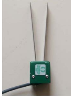
Şekil 3.14. Çatlak açıklığı ölçüm aparatı (clip gage).
