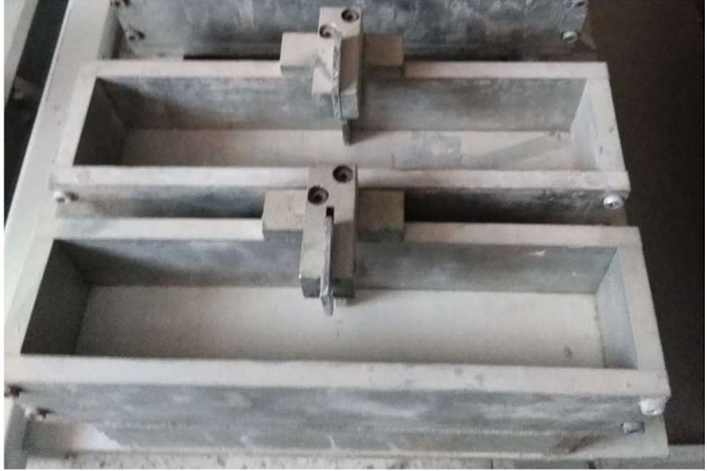
Şekil 3.4. Çalışmada kullanılan çentikli kiriş kalıpları.
