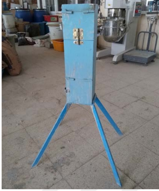
Şekil 3.10. Kolon segregasyon deney düzeneği.
