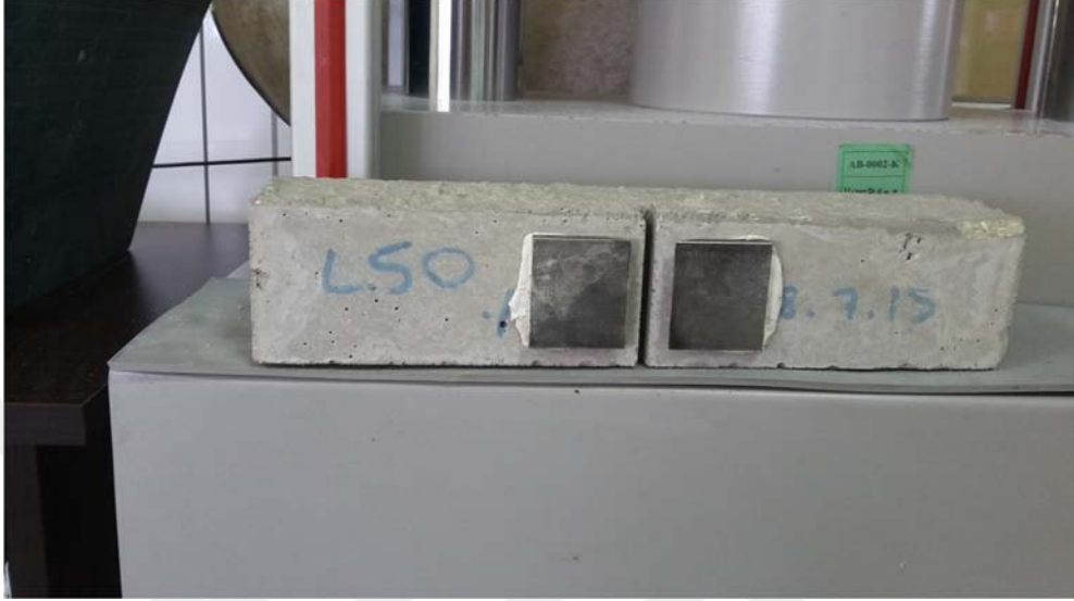
Şekil 3.12. Kırılma enerjisi deney düzeneği için numunenin hazırlanması.
