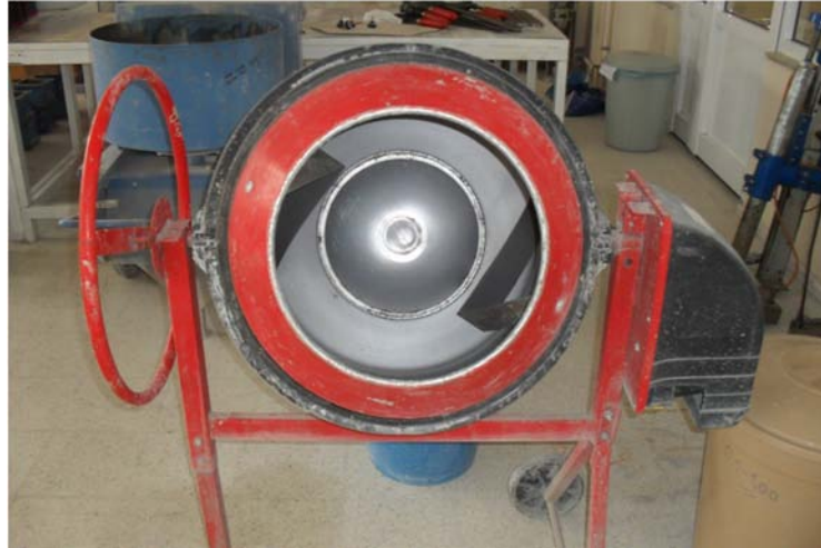
Şekil 3.6. Beton karışımında kullanılan mikser.
