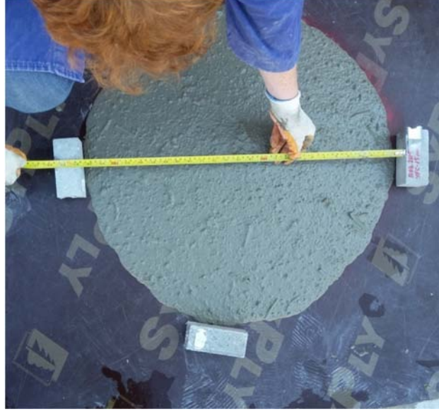
Şekil 3.8. Lastik agrega ikameli KYB yayılımı.
