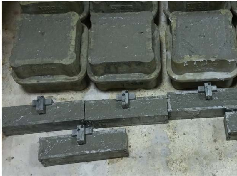
Şekil 3.7. Beton karışımının kalıplara yerleştirilmesi.
