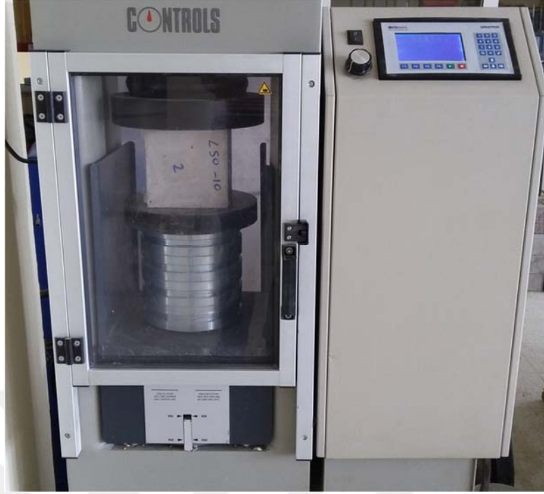
Şekil 3.11. Beton basınç dayanımında kullanılan pres.
