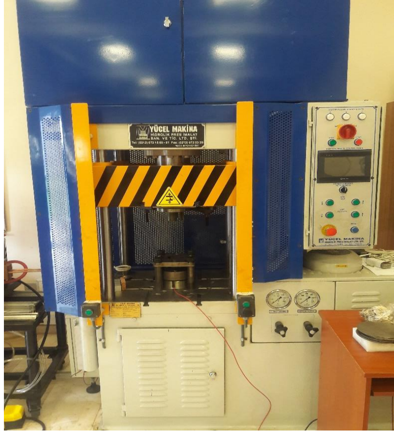
Şekil 6.19. PLC kontrollü derin çekme presi.
