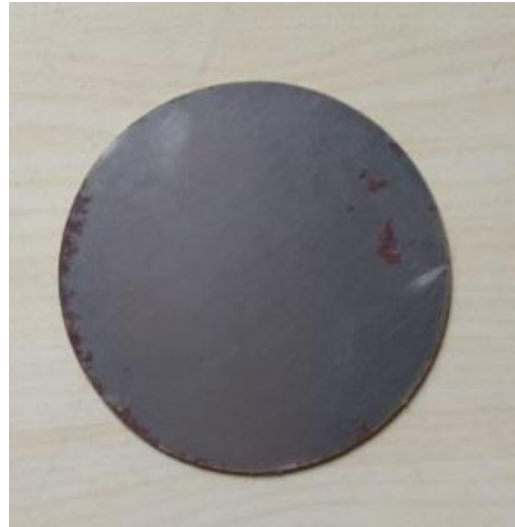
Şekil 6.18. Docol DP800 deney malzemesi.
