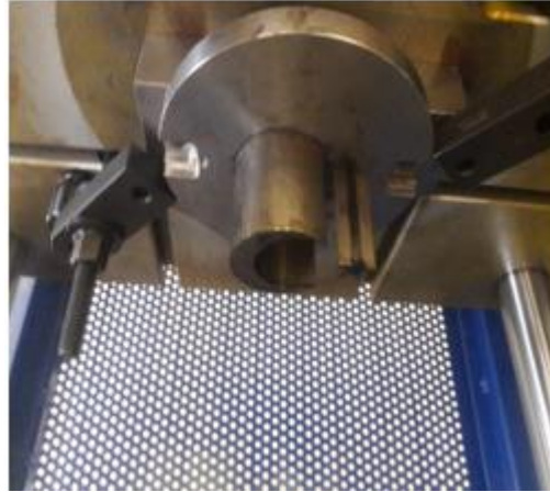
Şekil 6.21. Kesme zımbasının üst tablaya montajı.
