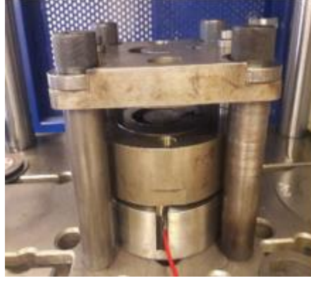
Şekil 6.22. Hassas kesme kalıbının prese montajı.
