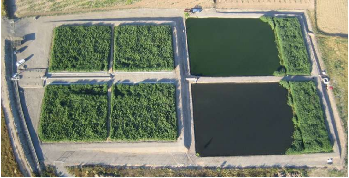
Şekil 1.65. Verdú, Catalonia'dan yapay sulak alan örnekleri (Samsó, 2014)
