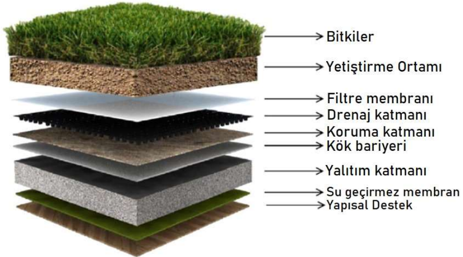
Şekil 1.48. Yeşil Çatı Katmanları, Kuppusamy'den uyarlanmıştır (2016)
