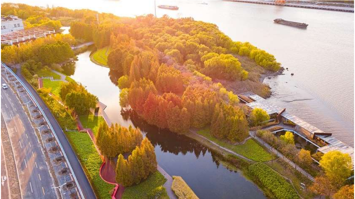
Şekil 2.66. Houtan Parkında, suyun hareketini yavaşlatmak için otoyol ile nehir arasında riparian teraslar oluşturulmuştur (TCLF, 2024)
