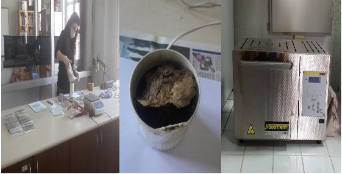
Şekil 2.8. Örneklerin toz haline getirilmesi ve kül fırınında yakma işleminin yapılması.
