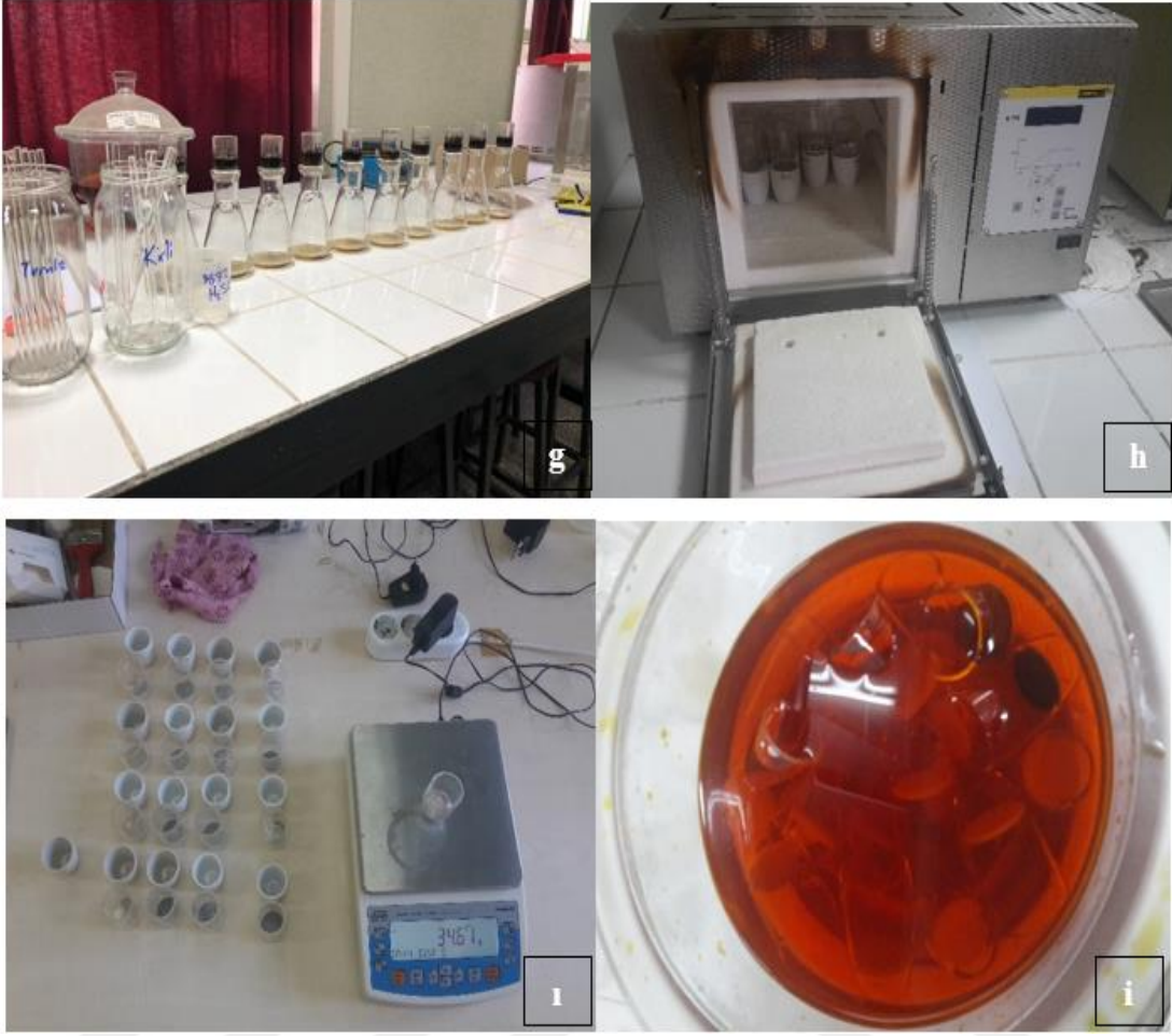
Şekil 2.10. g) İkinci defa asitli işlem uygulanması, h) Örneklerin kül fırınında yakılması, i) Örneklerin tartılması, j) Krozelerin temizliği için asite yatırılması.
