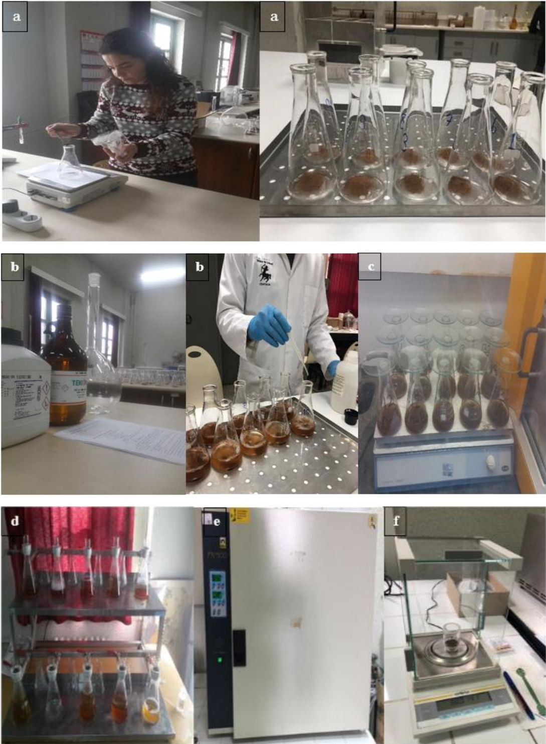
Şekil 2.9. a) Örneklerin analizler için hazırlanması, b) Hazırlanan asit çözeltisinin örneklere ilavesi, c) Hot plate üzerinde kaynatma işlemi, d) Vakumlu düzenekte örneklerin asit çözeltisinden arındırılması, e) Kurutma fırınında örneklerin kurutulması, f) Fırın kuru haldeki örneklerin tartılması.
