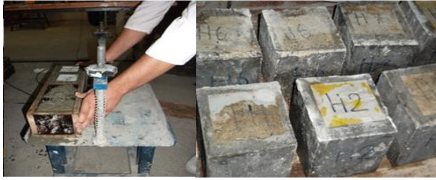
Şekil4. Beton küp numunelerin imalatı
