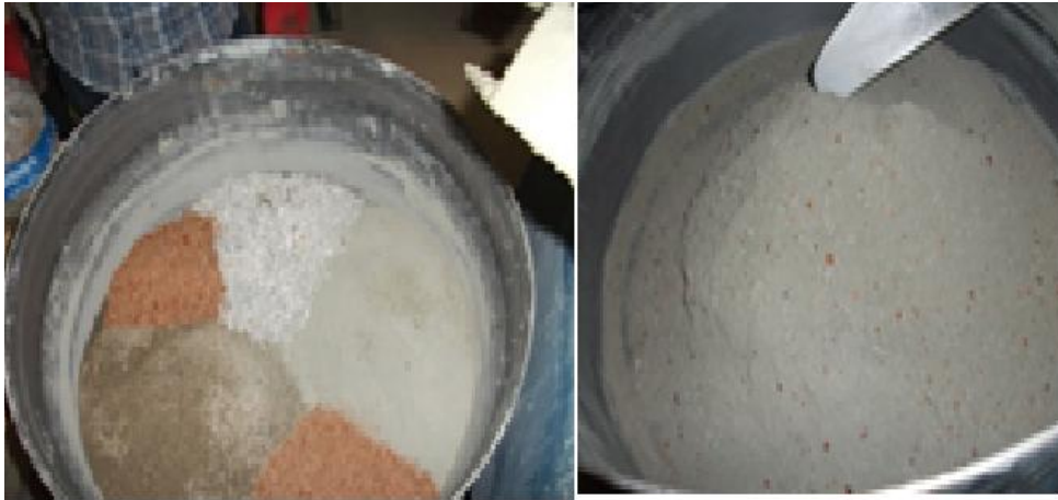
Şekil .2 Fındık kabuğu ilaveli beton hazırlığı
