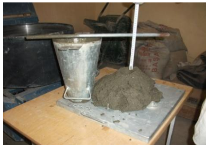
Şekil.3 Betonda yapılan slump deneyi
