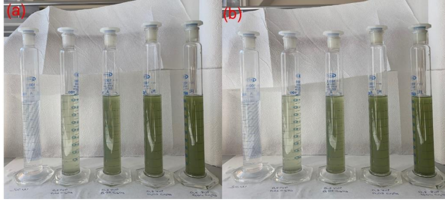
Şekil 4.47. PVP sürfaktanı kullanılarak hazırlanan \text{Cr}_2\text{O}_3 NF'lerin (a) 1 ve (b) 24 saat sonraki görüntüleri.
