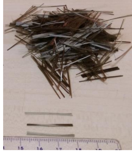
Şekil 3: 24 mm uzunluğunda bazalt lifler.
