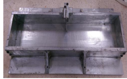
Şekil 4: Çentikli kiriş numunelerinin üretiminde kullanılan çelik kalıp.
