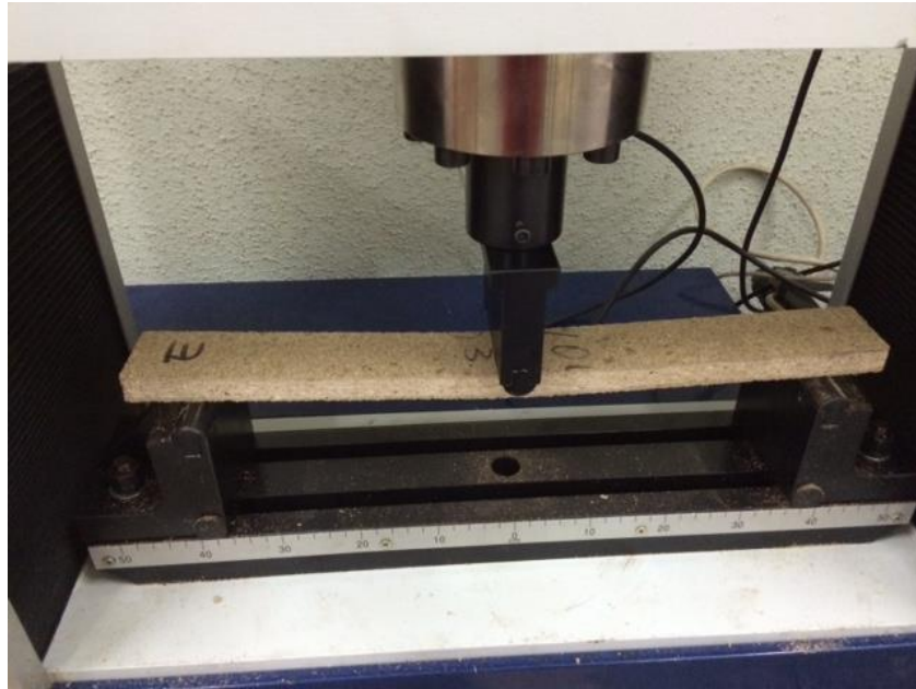
Şekil 2.5. Eğilme direnci ve elastikiyet modülü deneyi test görüntüsü.
