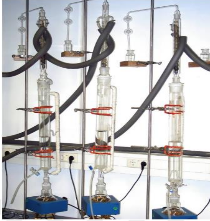
Şekil 2.6. Formaldehit emisyon miktarı belirleme düzeneği.
