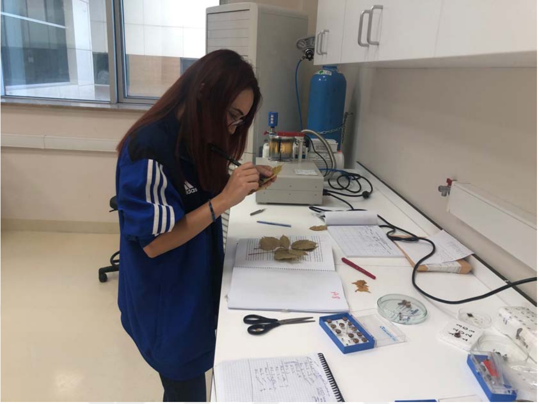
Şekil 3.9. Sputter Coater cihazına örneklerin hazırlanması
