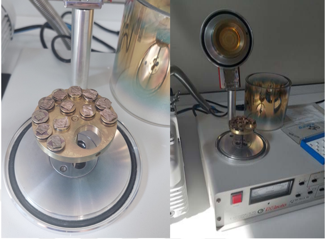
Şekil 3.10. Altın kaplaması yapılmış yaprak örnekleri ve Sputter Coater cihazı
