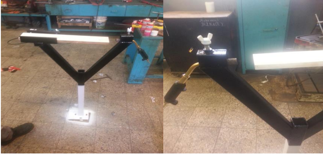
Şekil 3. Fabrikada hazırlanan yanma dayanım düzeneği.
