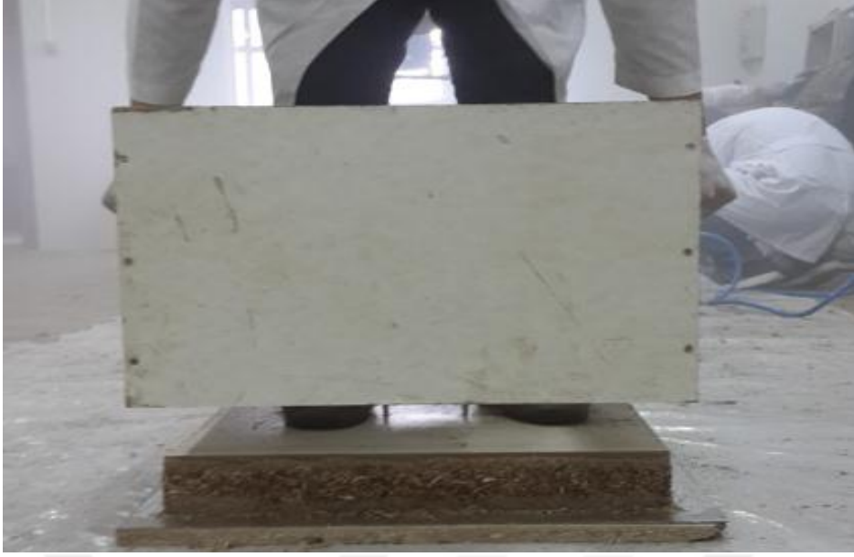
Şekil 2.11. Soğuk presleme sonrası taslak şekillendirme levhasının uzaklaştırılması.
