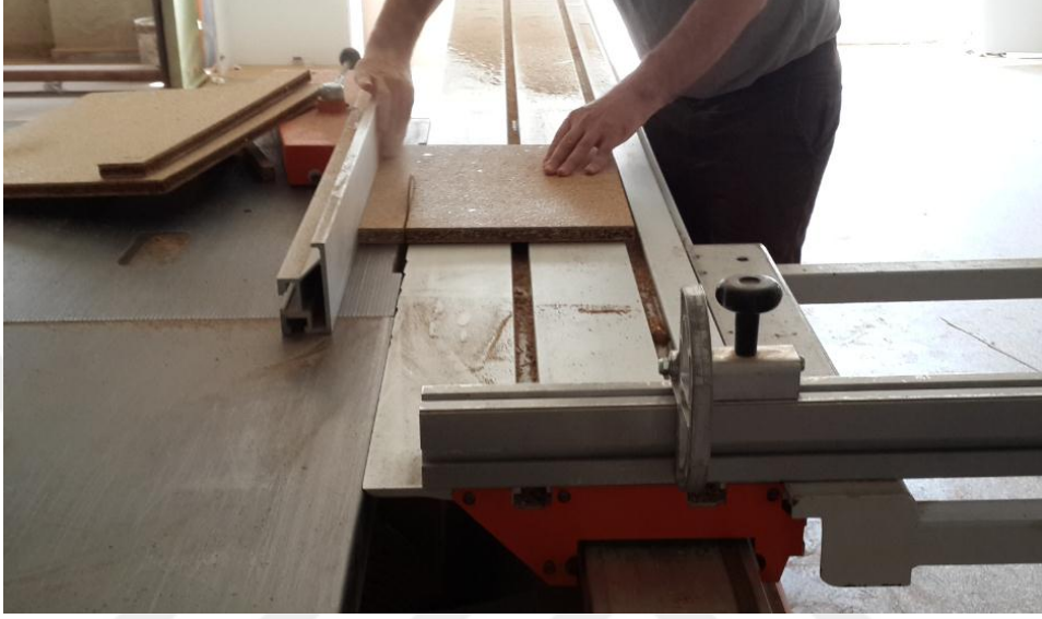
Şekil 2.15. Daire testerede yongalevhadan test örneklerinin hazırlanması.
