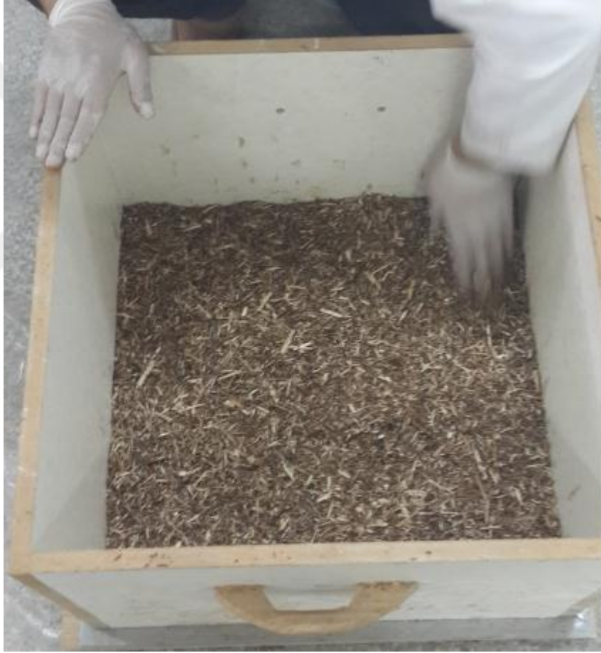
Şekil 2.10. Yongalevha üretiminde levha taslağının hazırlanması (orta tabaka).
