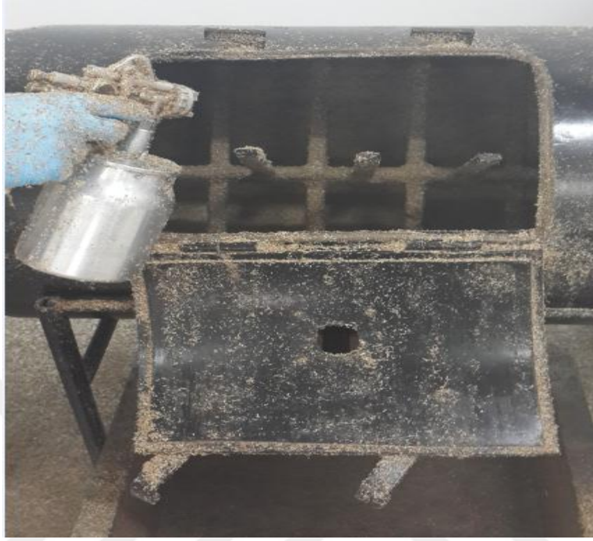
Şekil 2.8. Levha üretiminde kullanılan tutkallama düzeneği.
