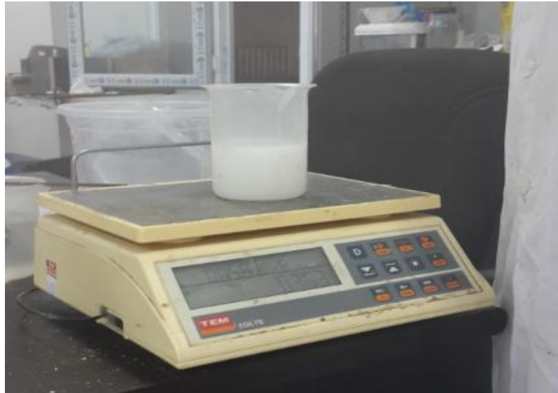
Şekil 2.7. Levha üretiminde kullanılacak tutkal miktarının terazi ile ölçülmesi.
