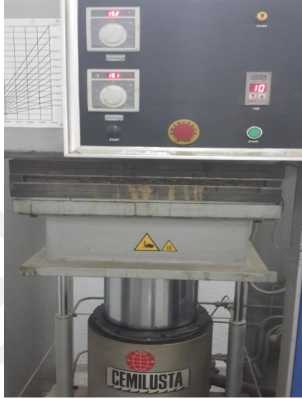
Şekil 2.13. Taslak levhalara sıcak pres uygulama aşaması.
