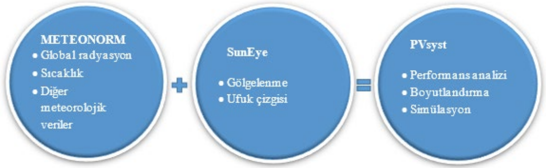
Şekil 7.3. PVsyst, Meteonorm ve SunEye arasındaki ilişki.
