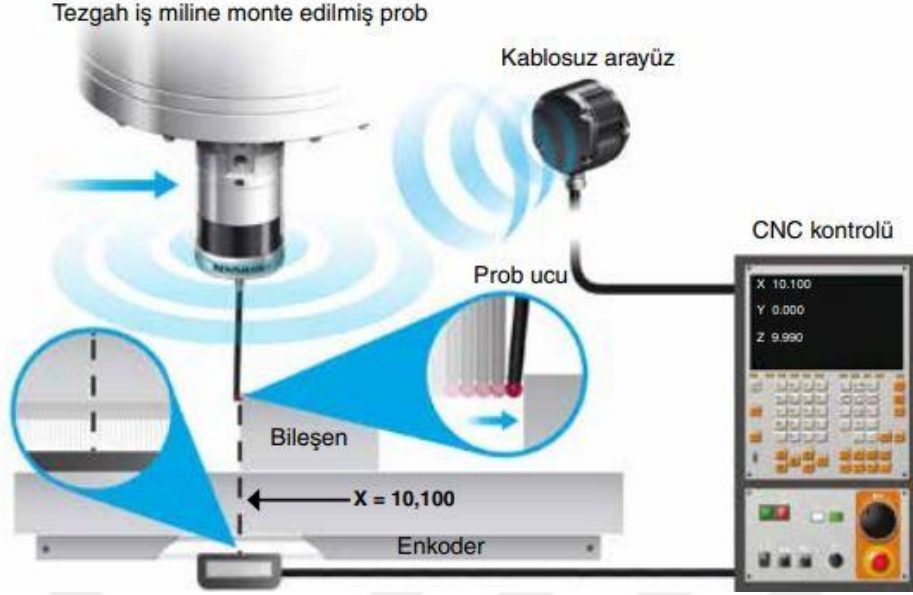
Şekil 2.8. Renishaw ölçüm cihazının çalışma prensibi [24].
