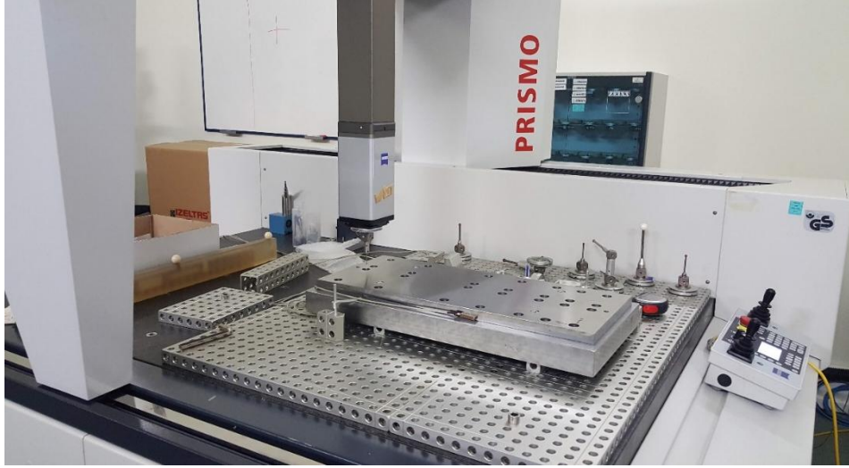
Şekil 5.14. Delikleri delinen parçanın delikler arası mesafe ölçümü.
