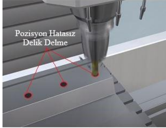
Şekil 2.18. Tezgâhın soğuk çalışması a) Sıcaklıktan etkilenmemiş vidalı mil b) Sıcaklıktan etkilenmemiş servo motorlu vidalı mil hareket sistemi c) Sıcaklık etkisi olmadan delik delme [44].
