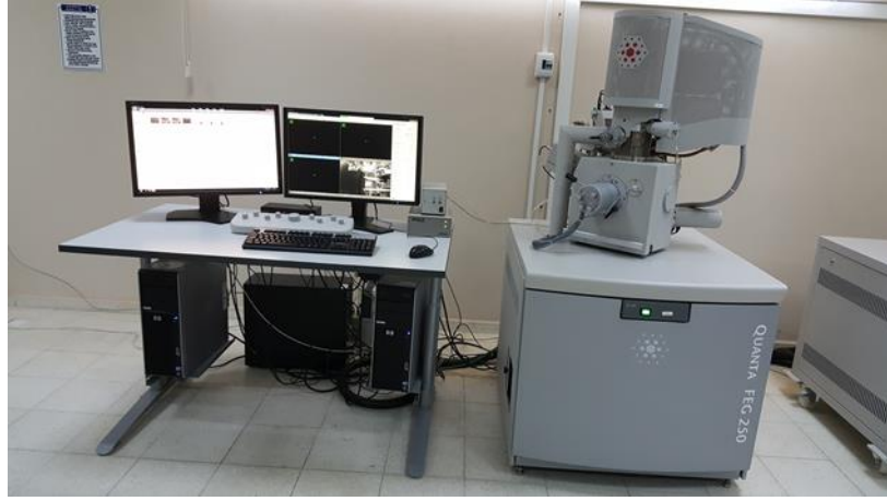
Şekil 8.3. Taramalı elektron mikroskobu (SEM) ölçümleri.
