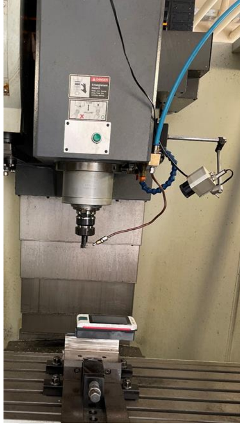
Şekil 8.2. Kesme sıcaklığı ve yüzey pürüzlülüğü ölçümü.
