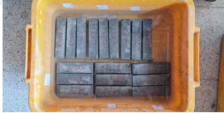
Şekil 3.8. Harç numunelerinin kür ortamında bekletilmesi.
