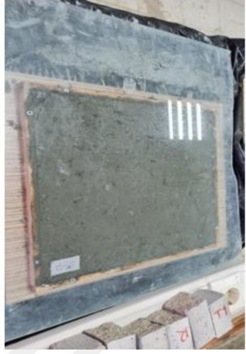
Şekil 3.9. Elektromanyetik deneyi için üretilen karo numuneler.
