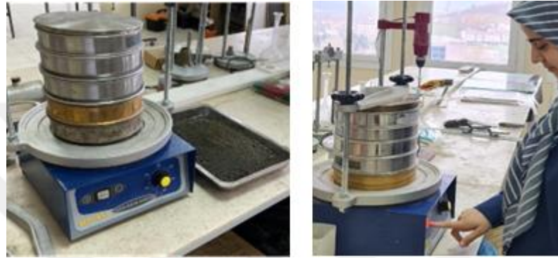
Şekil 3.3. Bakır cürufunun öğütülmesi ve eleme aşamaları.
