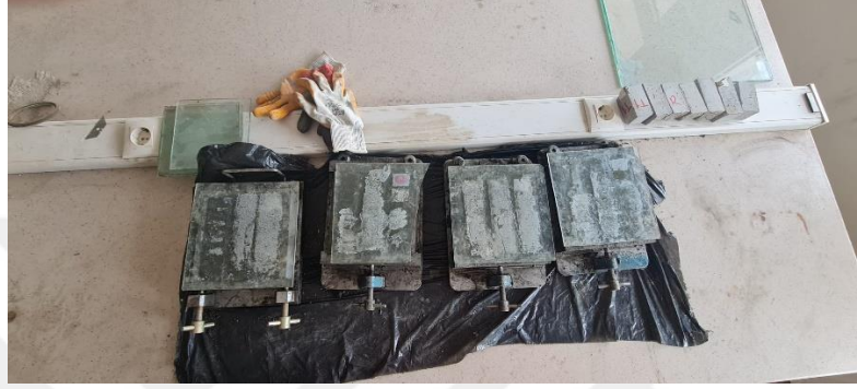
Şekil 3.7. Kalıplara yerleştirilmiş harç numuneleri.
