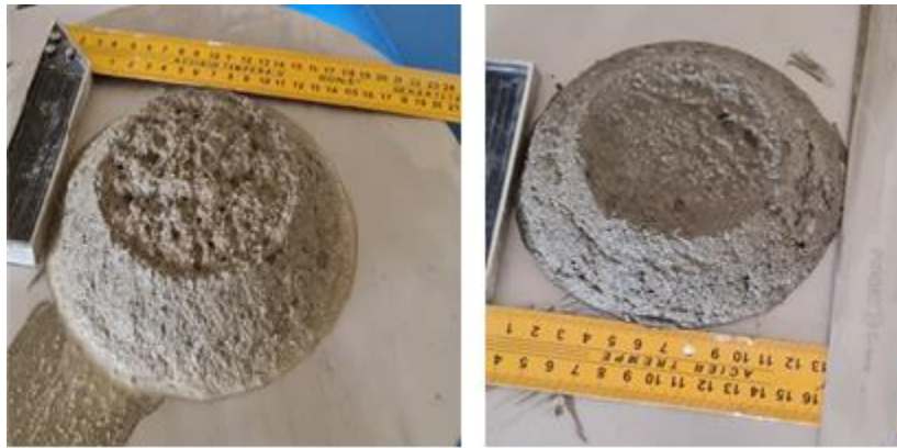
Şekil 3.6. Yayılma deneyi uygulanmış harç örnekleri.
