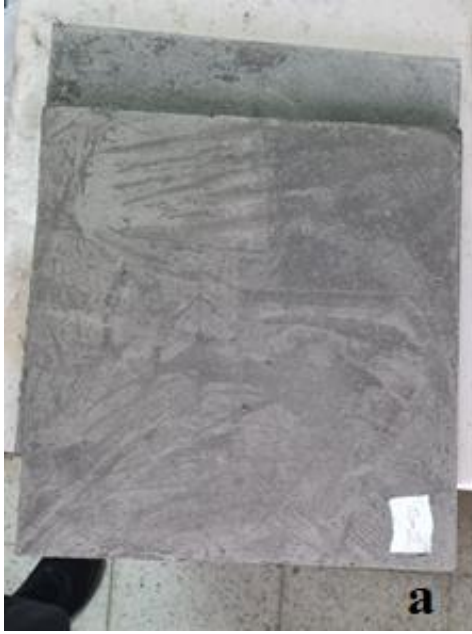
Şekil 3.10. a) Kalıptan çıkarılan karo numuneler b) Kür teknesi.
