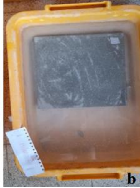
Şekil 3.10. a) Kalıptan çıkarılan karo numuneler b) Kür teknesi.
