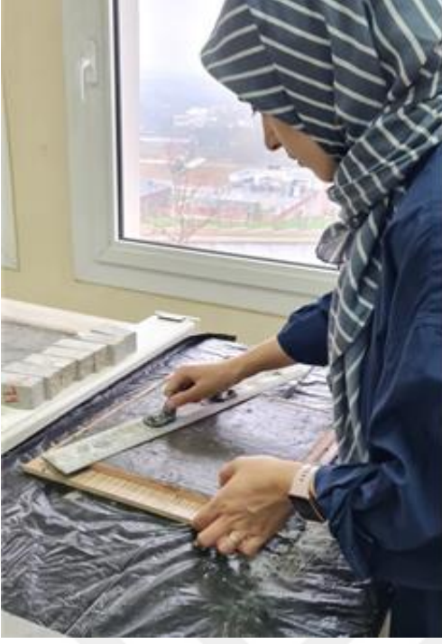
Şekil 3.9. Elektromanyetik deneyi için üretilen karo numuneler.
