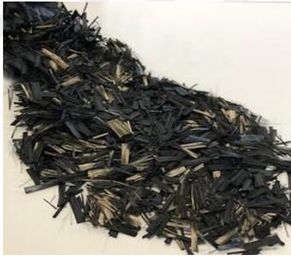
Şekil 3.4. Deneylerde kullanılan kırılmış karbon lifler.
