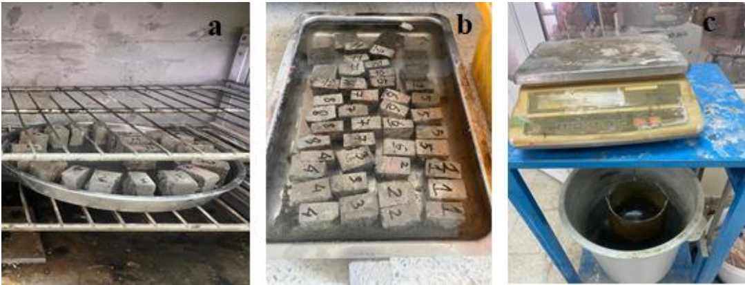
Şekil 3.9. Harçların fiziksel deneyleri a) Etüvde kurutulması b) Suda bekletilmesi, c) Arşimet terazisi tartımı.
