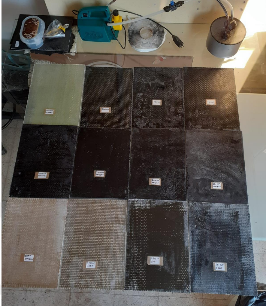
Şekil 3. 15. Üretilen barit, manyetit ve CNT grubu plakalar.
