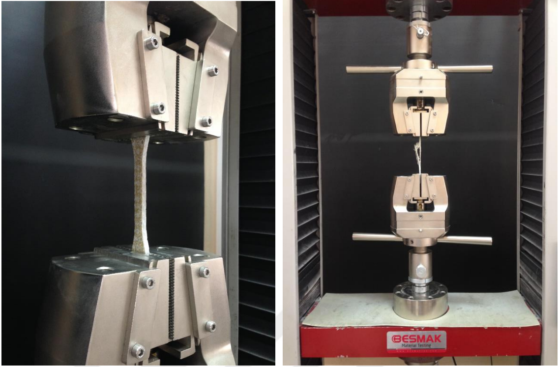
Şekil 3. 20. Üretilen kompozit numunelerin çekme dayanımı testi.
