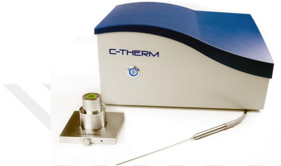
Şekil 3. 27. Termal iletkenlik katsayı ölçüm cihazı.
