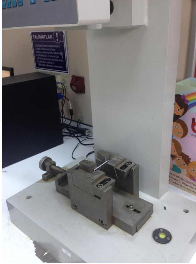
Şekil 3. 26. Kompozit numunelere uygulanan Charpy darbe dayanımı testi.
