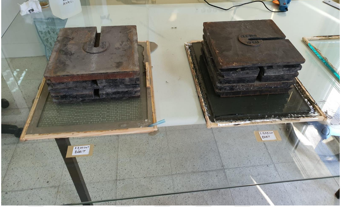
Şekil 3. 14. El yatırması yöntemiyle üretilen kurlenme sürecindeki kompozit plakalar.
