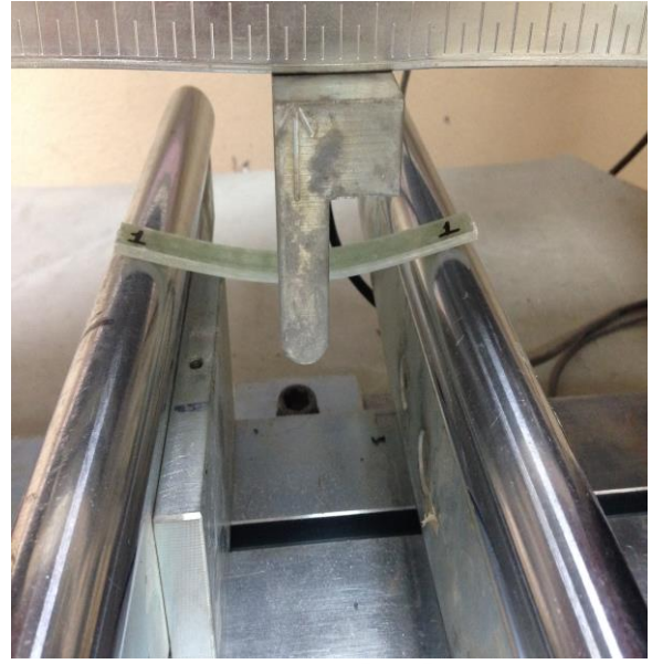
Şekil 3. 23. Kompozitlerin eğilme dayanımı testi.
