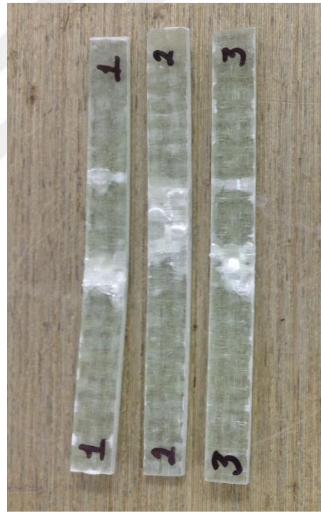
Şekil 3. 24. Eğilme dayanımı deneyi öncesi ve sonrası numune görselleri.
