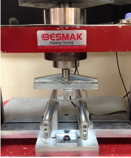
Şekil 3. 23. Kompozitlerin eğilme dayanımı testi.
