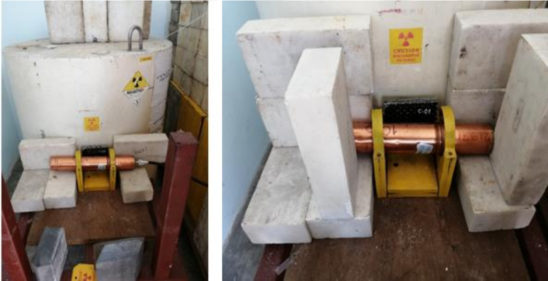
Şekil 3. 32. Nötron radyasyonu zırlama deneyi.
