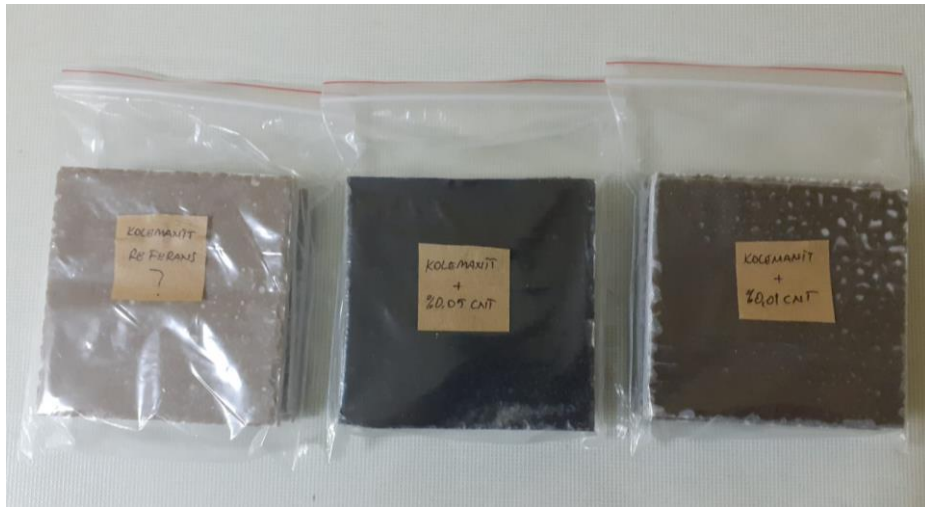
Şekil 3. 30. Gama ve Nötron geçirgenlik deneyleri için hazırlanan numuneler.
