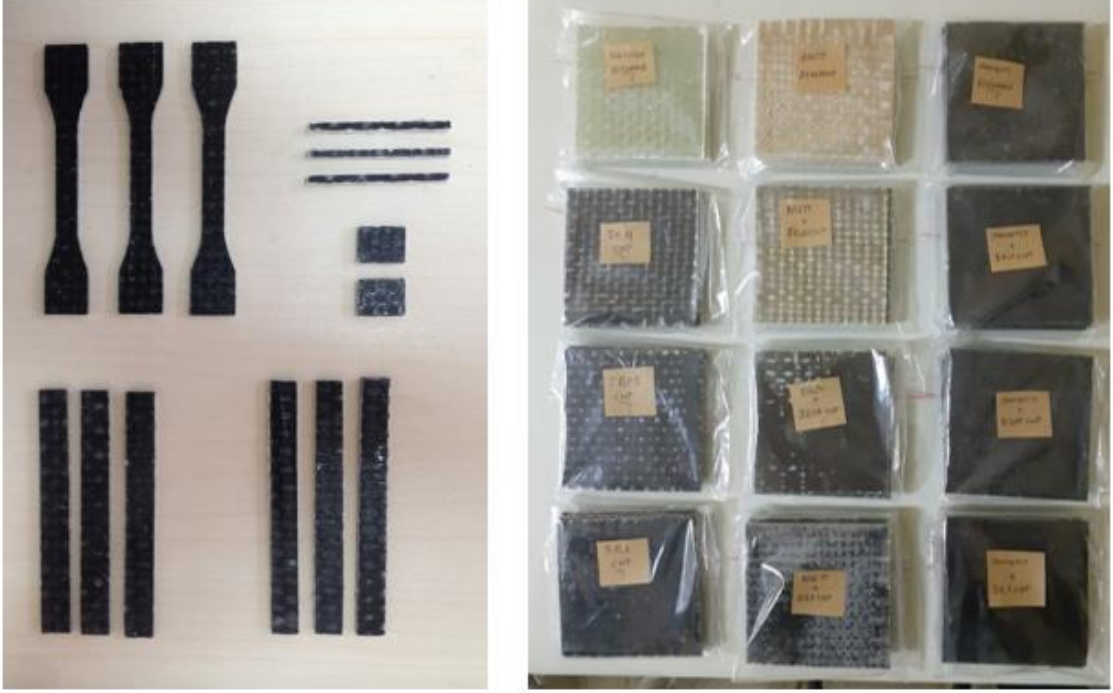
Şekil 3. 17. Farklı testler için kesilerek hazırlanan deney numuneleri.
