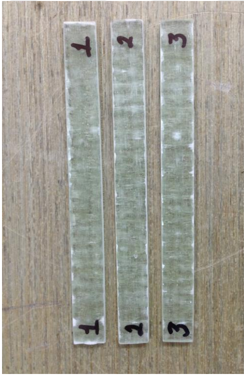
Şekil 3. 24. Eğilme dayanımı deneyi öncesi ve sonrası numune görselleri.
