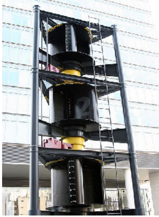
Şekil 2.7 Savonius Rotorlu Rüzgâr Türbini [22]
