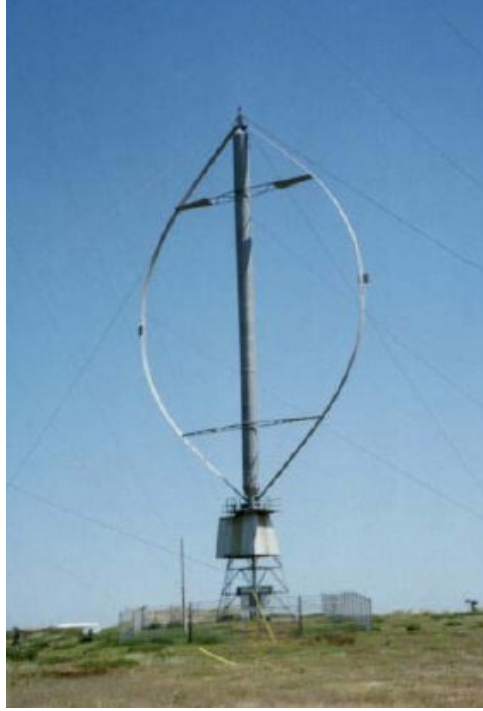
Şekil 2.6 Düşey Eksenli Rüzgâr Türbini [21]
