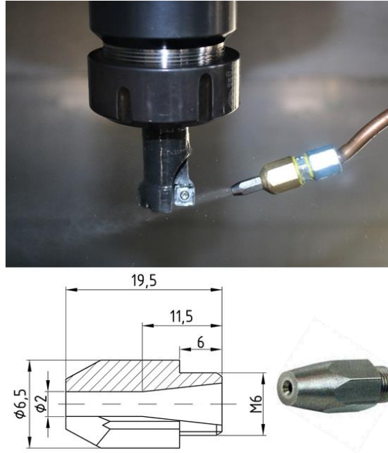
Şekil 6.2. MMY deneylerinde kullanılan nozul boyutları.
