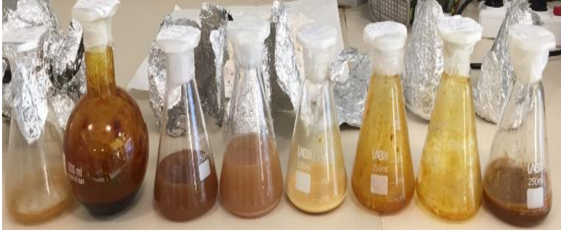
Şekil 3.7. Farklı çözücüler kullanılarak elde edilen evaporasyon işlemine tabi tutulmuş ve bu işleme tabi tutulacak propolis ekstraktları.
