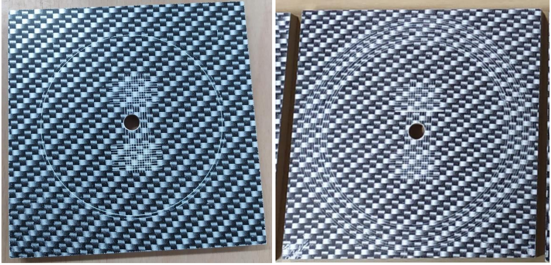
Şekil 5.9. (a) Akrilik lake boyalı MDF yüzeyine HGK yapılmış kontrol örneği, (b) MDF Lam yüzeylerine HGK yapıldıktan sonra çamaşır suyu ile ovalama işlemi uygulanmış örnek.
