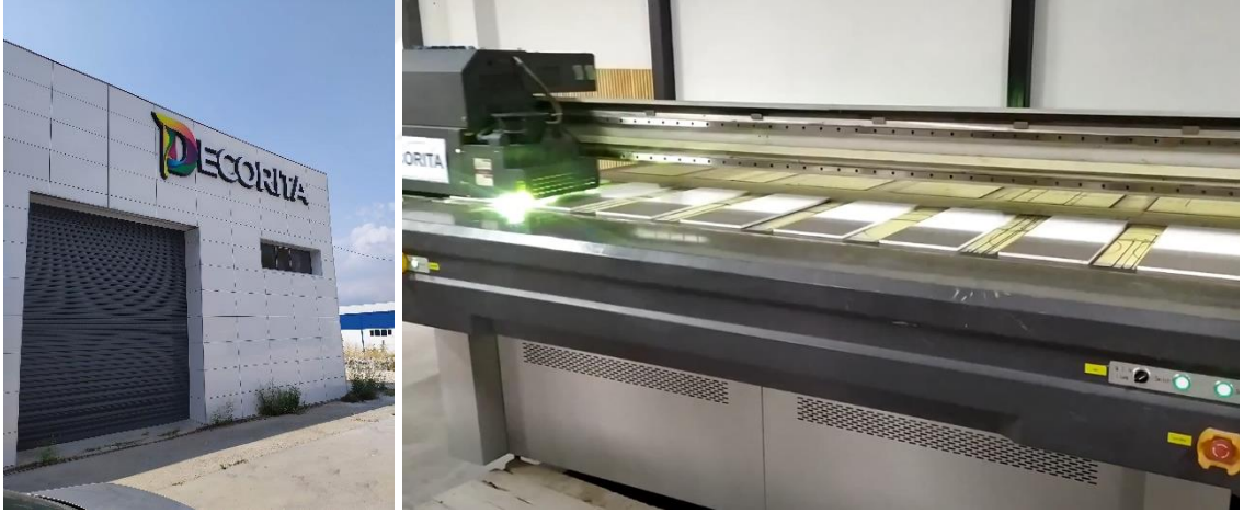
Şekil 4.10. UV baskı tekniğinin örnek levhalara uygulanması.
