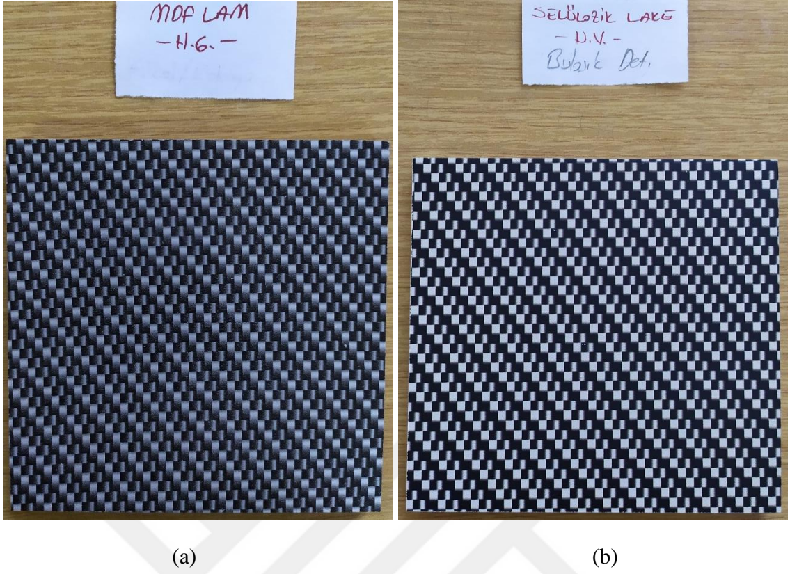
Şekil 5.10. (a) MDF Lam yüzeyine HGK yapılmış kontrol örneği, (b) Selülozik lake boyalı MDF yüzeylerine UV baskı işlemi yapıldıktan sonra bulaşık deterjanı ile ovalama işlemi uygulanmış örnek.
