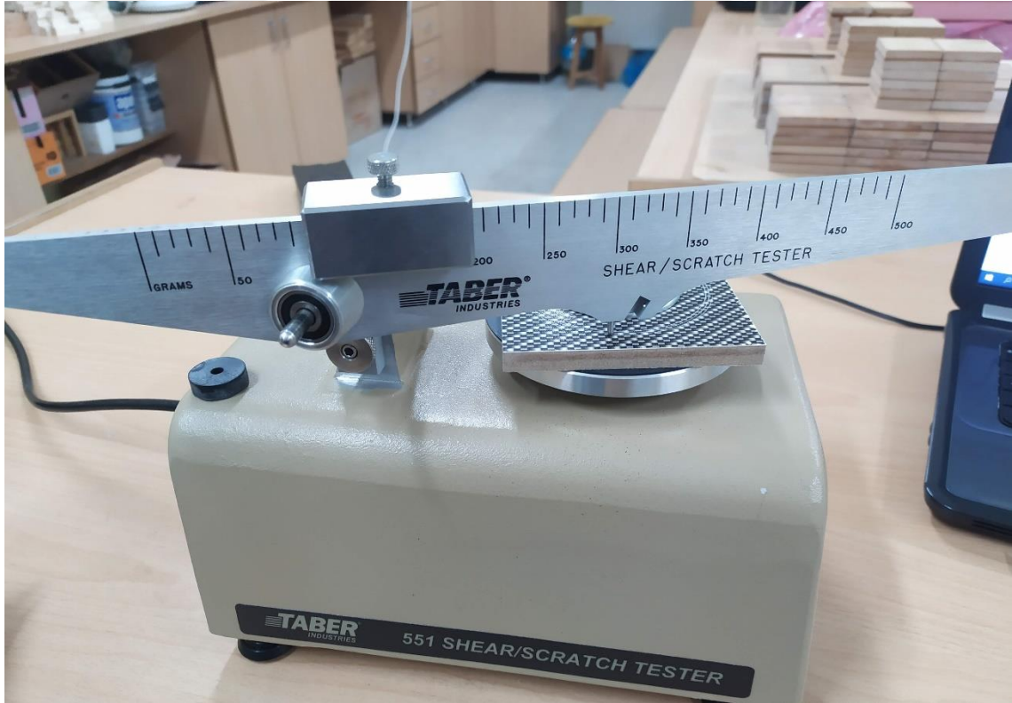
Şekil 4.39. TABER 551 Scratch marka cihaz ile çizilme testi.
