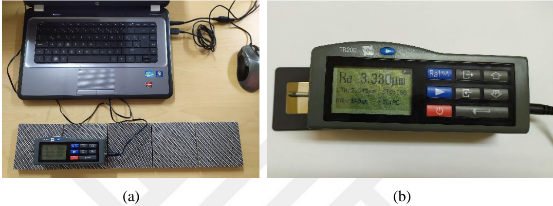
Şekil 4.41. (a) Örneklerin pürüzlülük ölçümü, (b) Cihazın kalibrasyonu.
