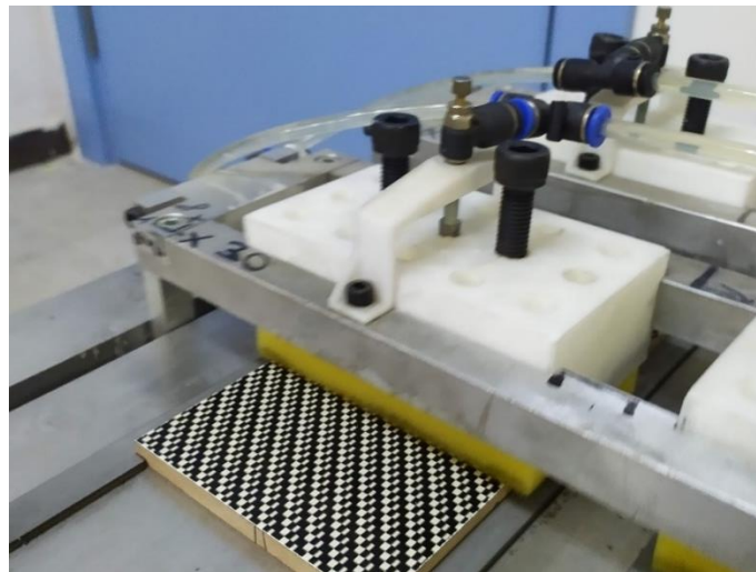
Şekil 4.19. Ovalama başlığı ve sıvı akış sisteminin çalışması.
