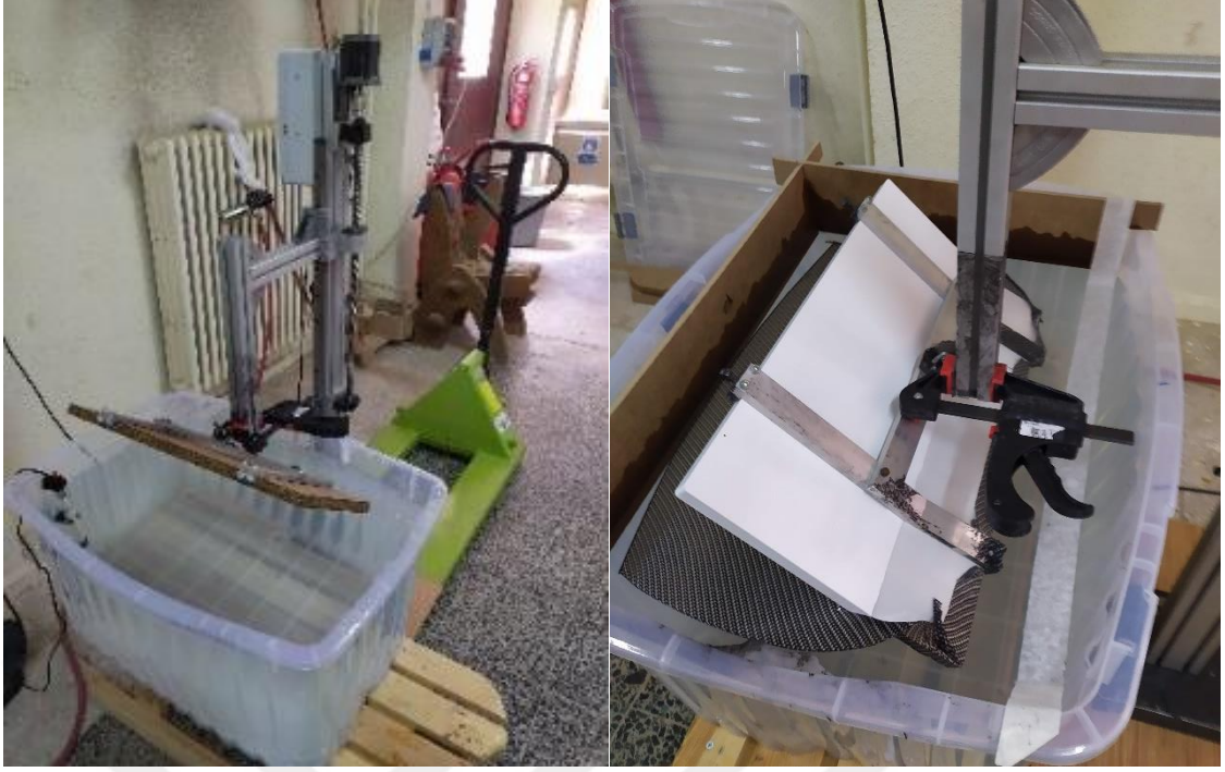
Şekil 4.6. Otomatik daldırma cihazı ile HGK uygulaması.
