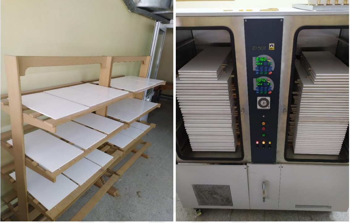
Şekil 4.3. Lake boyama işlemi tamamlanan örneklerin oda koşullarında kurutulması ve ardından örneklerin tekrar iklimlendirilmesi.
