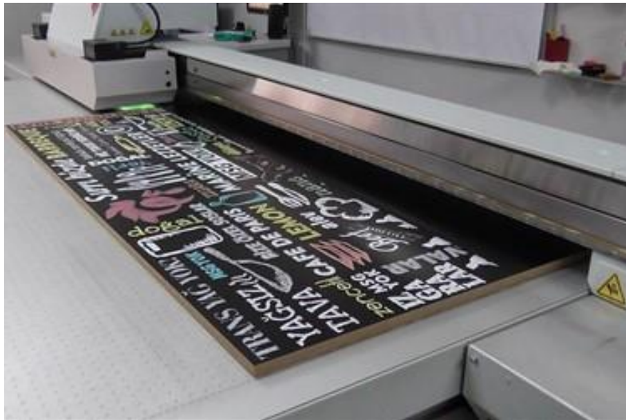
Şekil 2.6. UV baskı makinesi ve baskı işlemine bir örnek [91].
