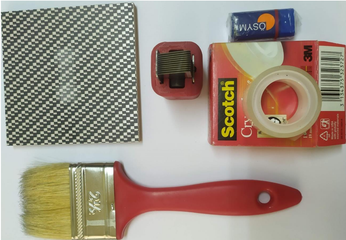
Şekil 4.38. Yapışma testi yapılmış örnek ve kullanılan ekipmanlar.
