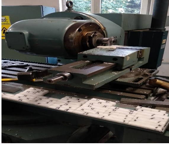
Şekil 5.19. Numunelerin freze tezgahında çentiklerin açılması.
