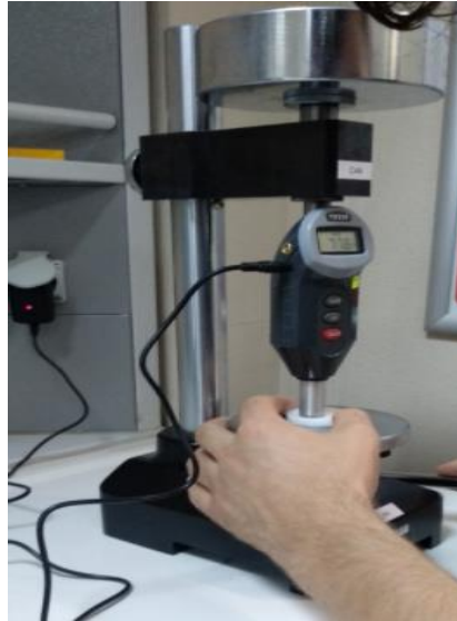
Şekil 5.18. Shore d sertlik deneyinin uygulanması.
