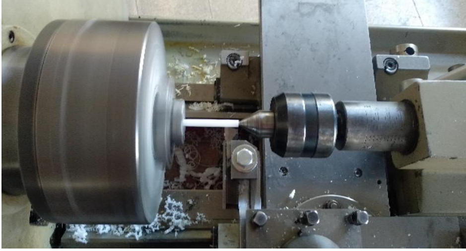
Şekil 5.10. Torna tezgâhında aşınma deney numunelerinin hazırlanma.
