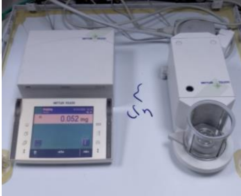
Şekil 5.16. Numunelerin kütle kaybının bulunmasında kullanılan hassas terazi.
