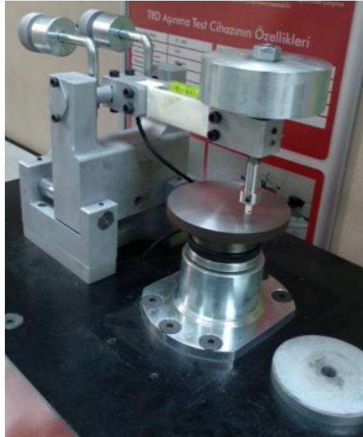
Şekil 5.15. Aşınma deney düzeneği.
