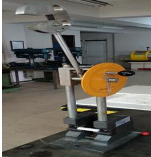
Şekil 5.20. Darbe deneyinin uygulanması.
