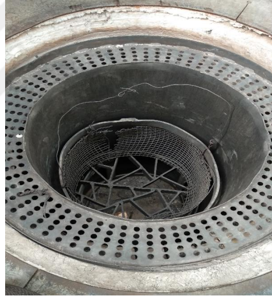
Şekil 5.12. Kriyojenik fırının temel görünümü.
