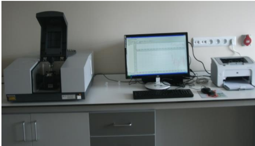
Şekil 5.22. Kızılötesi Spektrometresi (F-TIR) cihazı.
