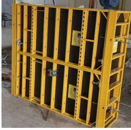
(a) Üretimlerde kullanılan kalıp sistemi
