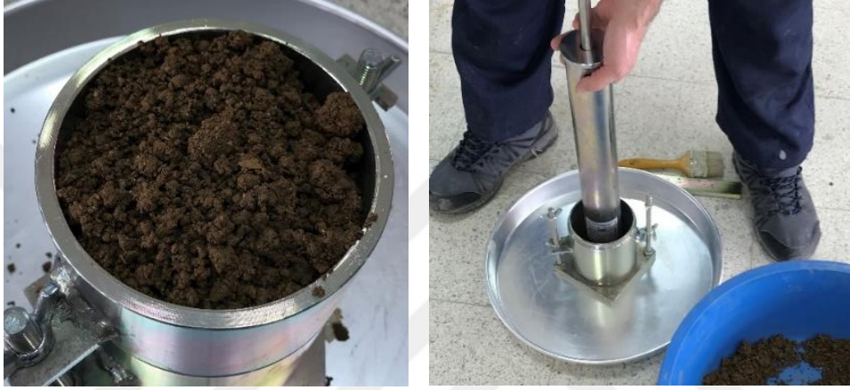
Şekil 2.8. Standart Proktor Deneyi.
