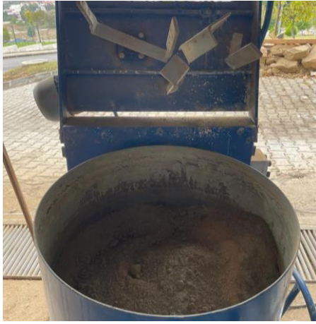
(b) Bıçaklı karıştırıcı yardımıyla karışımın hazırlanması
