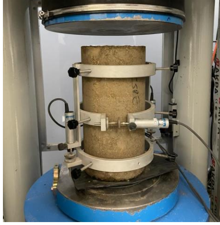
Şekil 2.11. Elastisite modülü test düzeneği.
