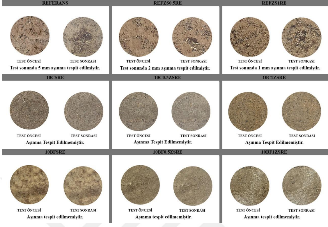
Şekil 3.7. Geelong damla erozyon test sonuçları.
