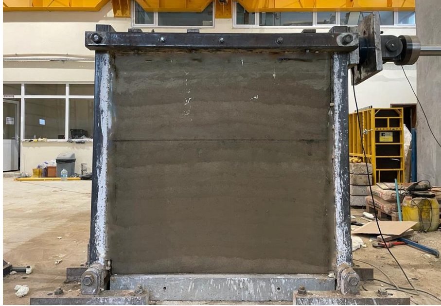
Şekil 2.20. Yükleme çerçevesi ve sıkıştırılmış toprak duvar.
