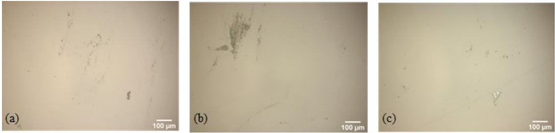
Şekil 3.4. 1 N Yük Altında a) Keçe Ped, b) CS-10 ve c) CS-8 ile Aşındırılan Kaplama C'nin Optik Mikroskop Görüntüleri.
