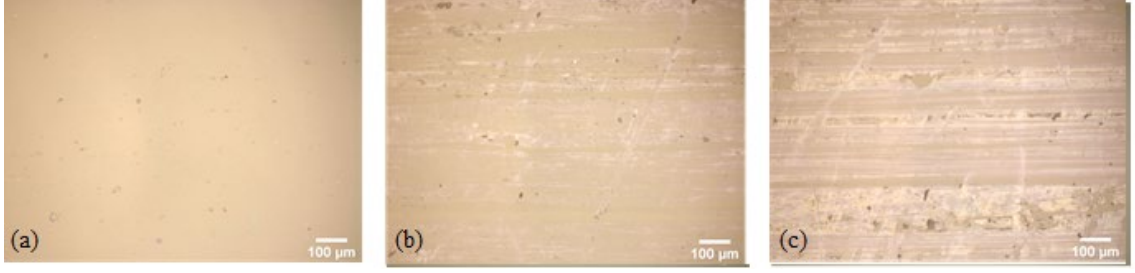
Şekil 3.5. 1 N Yük Altında a) Keçe Ped, b) CS-10 ve c) CS-8 ile Aşındırılan Kaplama B'nin Optik Mikroskop Görüntüleri.
