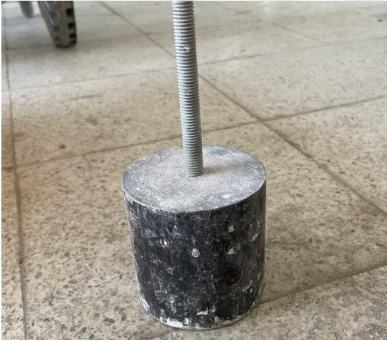
Şekil 3.8. Sıkıştırma ve masterlama işleminde kullanılan silindir demir profil.
