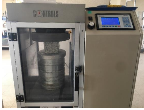
Şekil 3.11. Basınç test cihazı ve geçirimli beton numunesi.
