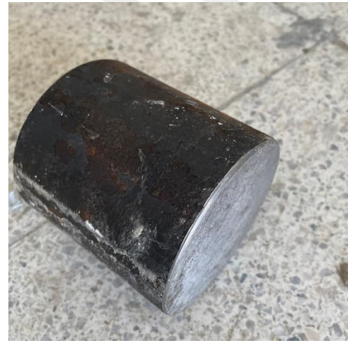
Şekil 3.8. Sıkıştırma ve masterlama işleminde kullanılan silindir demir profil.
