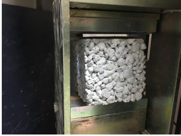
Şekil 3.13. Küp numunelerin yarmada çekme dayanım testi.
