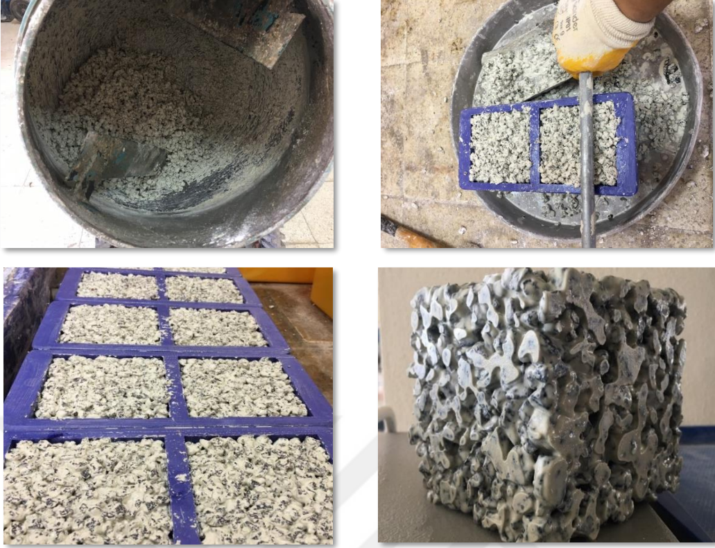
Şekil 3.6. Geçirimli beton birinci aşama numune hazırlama.
