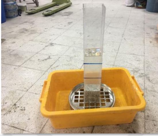
Şekil 3.15. Küp numunelerde geçirimlilik deney düzeneği.
