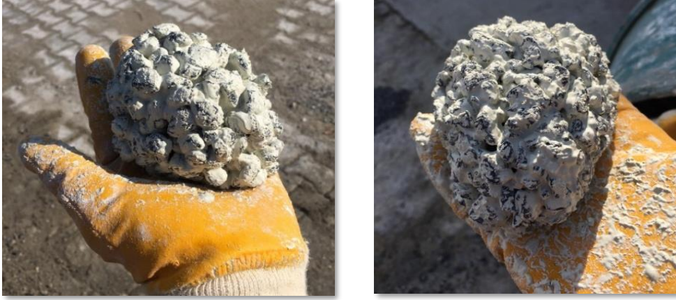
Şekil 3.10. Geçirimli betona kartopu deneyi yapılması.
