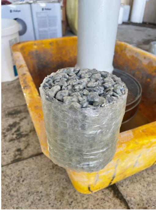
Şekil 3.16. Silindir numunelerde geçirimlilik deney düzeneği.
