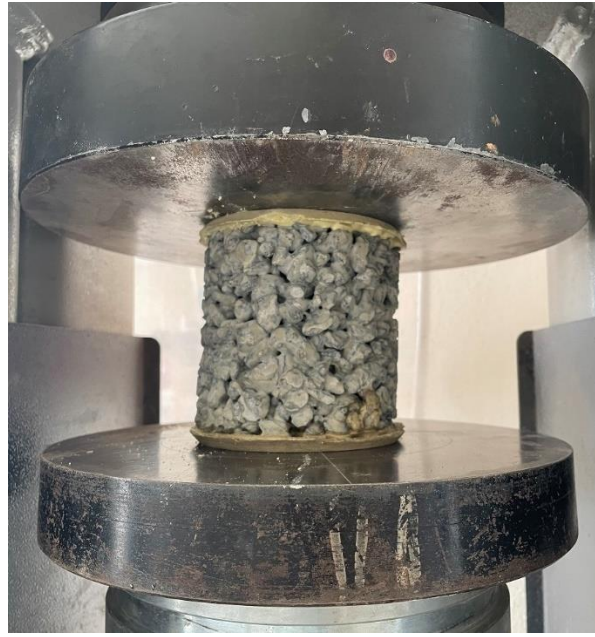
Şekil 3.12. Silindir geçirimli beton numunelerinin basınç deneyi.
