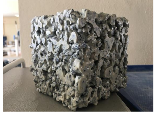
Şekil 3.11. Basınç test cihazı ve geçirimli beton numunesi.
