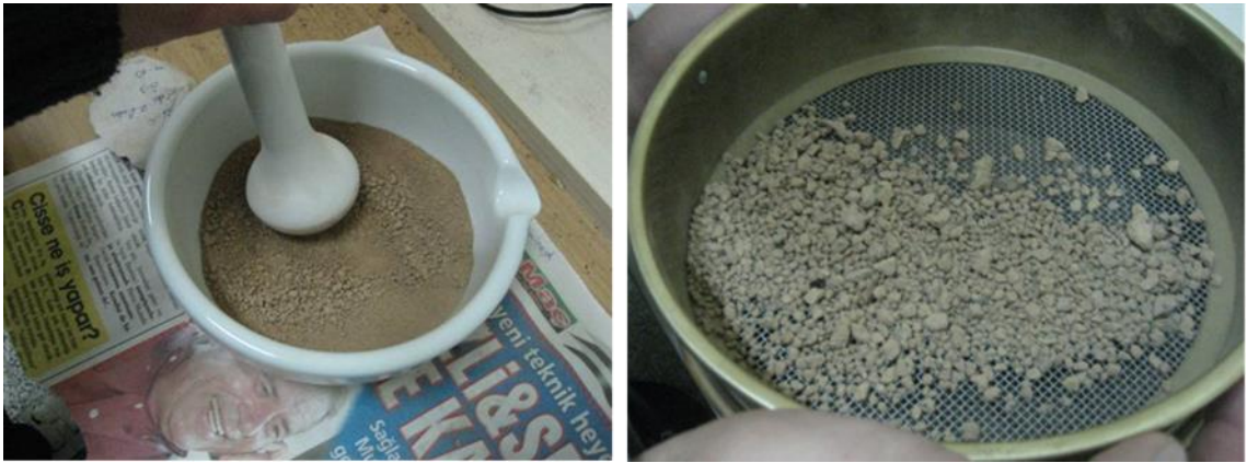
Şekil 2.22. Toprak örneklerinin dövülmesi ve elekten geçirilmesi.
