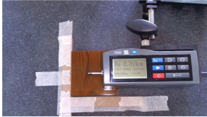
Şekil 1. Ahşap örneklerde pürüzlülük ölçümü.
