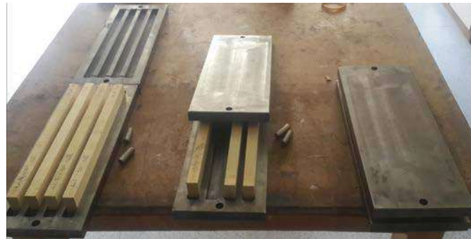
Şekil 1. Yoğunlaştırmada Kullanılan Metal Kalıplar ve Örneklerin Yerleşimi
