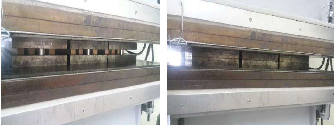
Şekil 2. Örneklerin Kalıp Yardımıyla Yoğunlaştırılması
