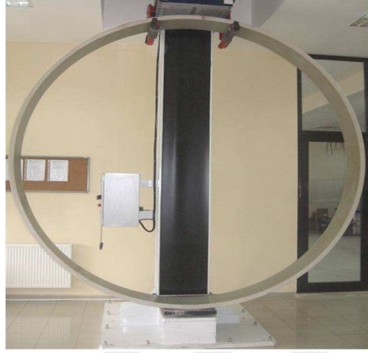
Şekil 2.13. Rijitlik deneyi sırasında defleksiyona tabi tutulmuş boru numunesi.
