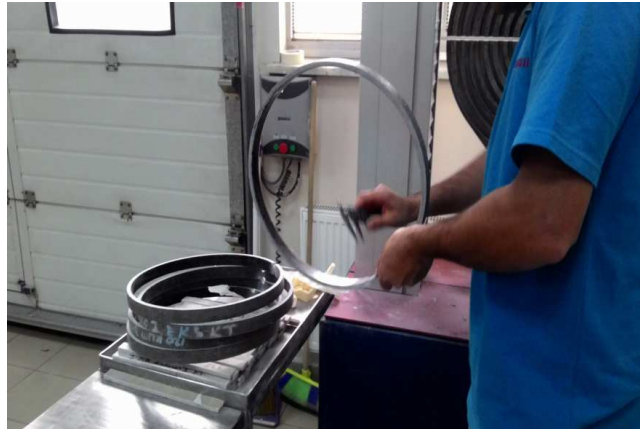
Şekil 3.18. Numunelerin test cihazına yerleştirilmeden önce ölçümlerinin yapılması.
