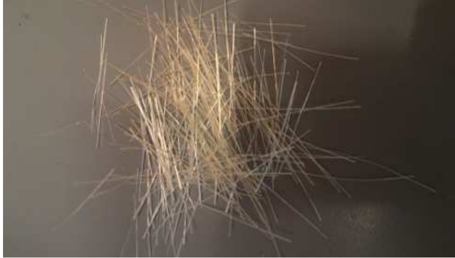
Şekil 3.1. Çalışmada takviye olarak kullanılan E-Cam elyafı.
