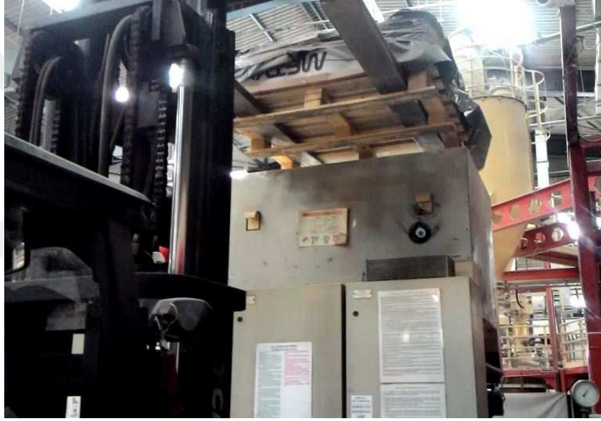
Şekil 3.8 UK- silis kumu karışımı dolgunun boru üretimi için hazırlanan hazneye aktarılması.
