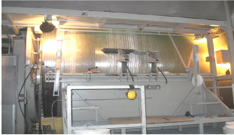
Őekil 2.7. S rekli elyaf sarma metodu ile CTP boru  retimini.
