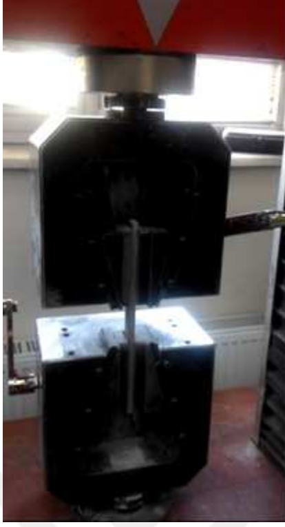
Şekil 2.16. Eksenel çekme a) Düzenegi b) Test cihazı.
