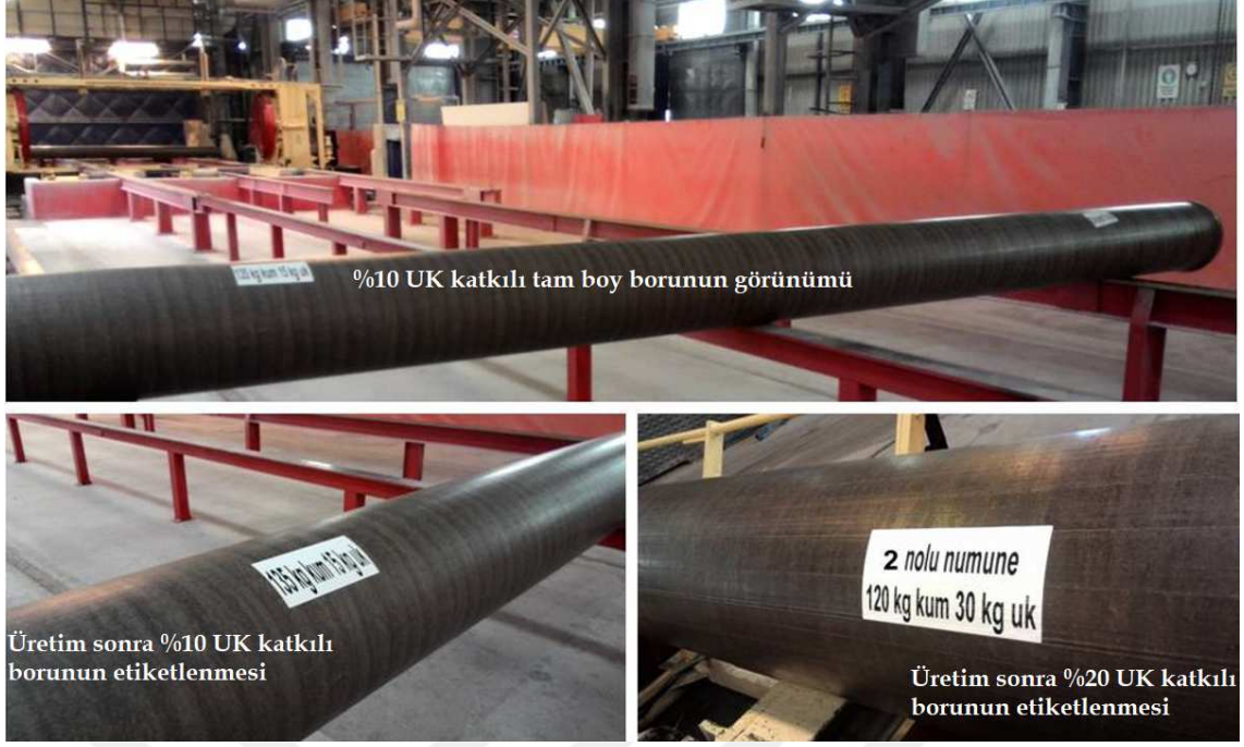
Şekil 3.12. Üretimi tamamlanan 2 adet - 6 mt boyunda UK katkılı boru numunesi.
