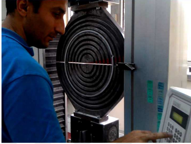
Şekil 3.19. Numunenin test çemberine yerleştirilmesi.
