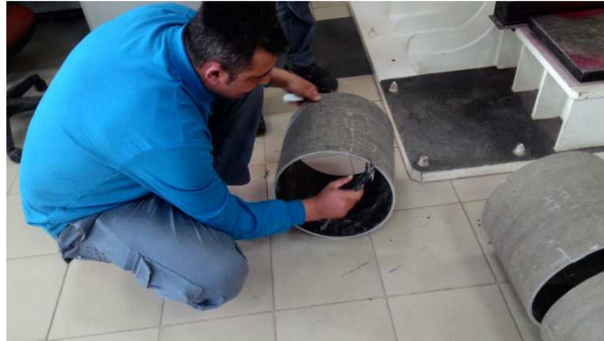
Şekil 3.15. Rijitlik test numunelerinin dijital kumpas ile ölçümü.
