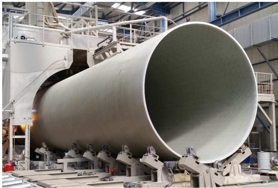
Őekil 2.8. S rekli elyaf sarma metodunda  retilen boru.
