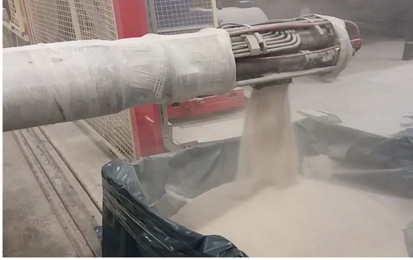
Şekil 3.7 Referans boru üretim sonunda silis kumunun boşaltılma anı.
