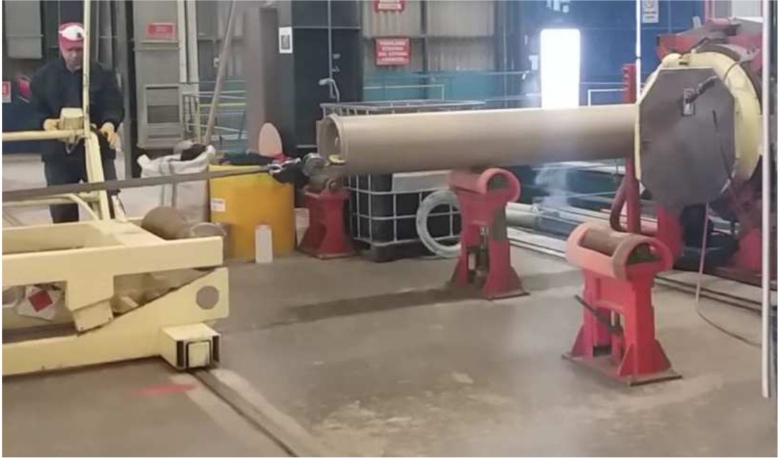
Şekil 3.6. Referans borunun döner kalıptan çıkarılması.
