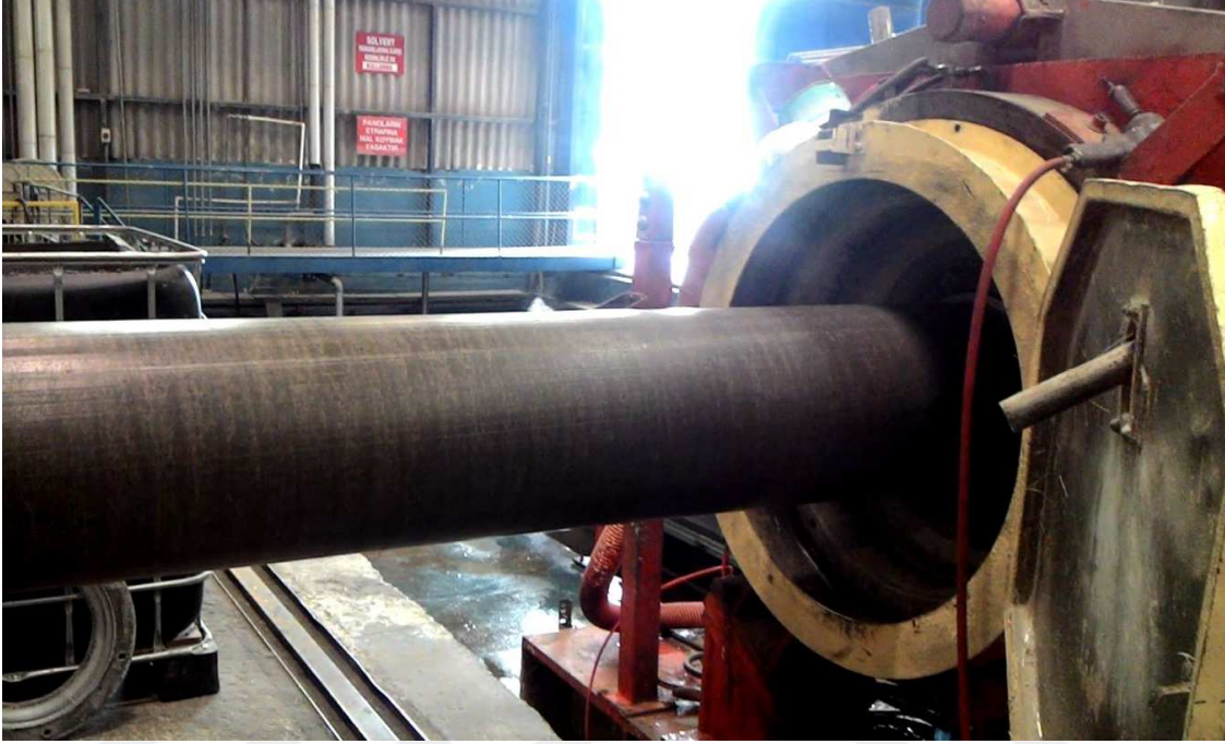
Şekil 3.11. %10 UK ikameli 1. No’lu boru numunesinin kalıptan çıkarılışı.
