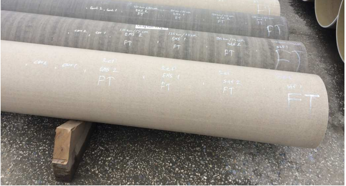
Şekil 3.13. Borularda test numunesi kesim noktalarının işaretlenmesi.
