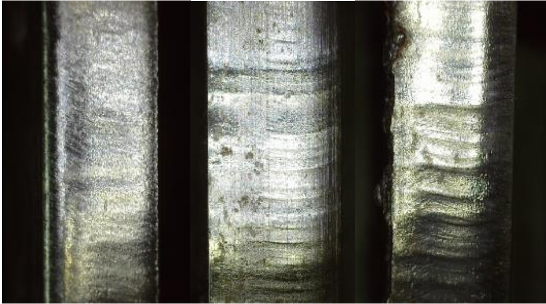
Şekil 6. 6 mm, 260A'de 50, 75 ve 100 mm/dk. kesim sonucunda yüzeylerin makro görünümü (x20)
