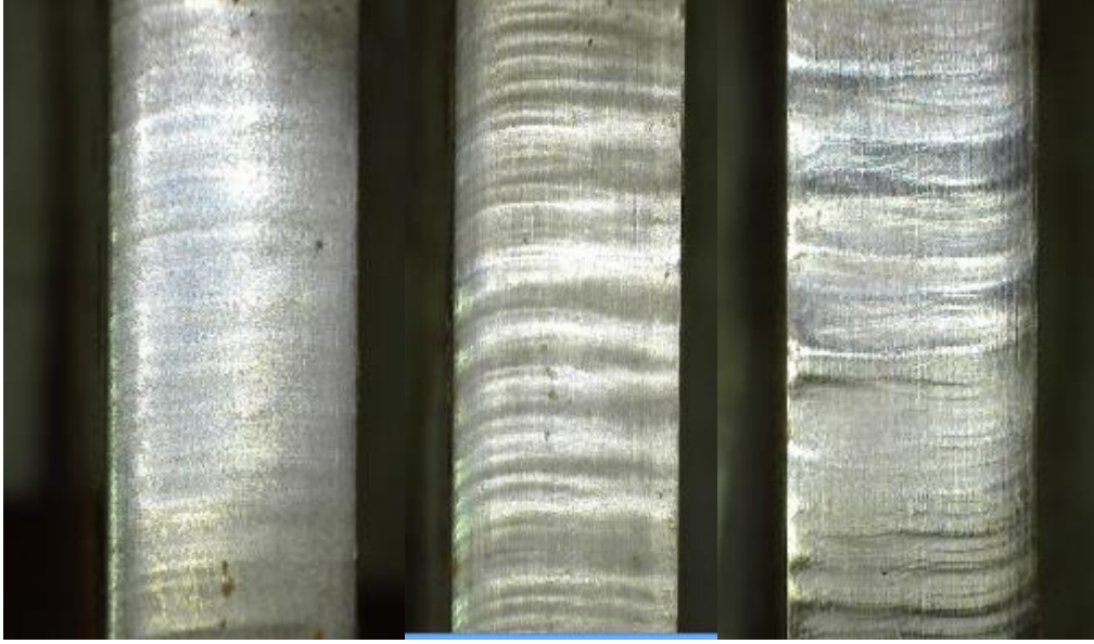
Şekil 5. 6 mm, 130A'de 50, 75 ve 100 mm/dk. kesim sonucunda yüzeylerin makro görünümü (x20)
