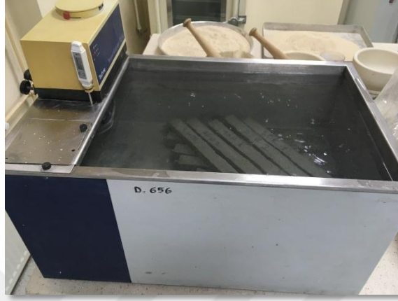
Şekil 3.17. Harç çubuklarının 80°C'deki NaOH çözeltisinde bekletilmesi.
