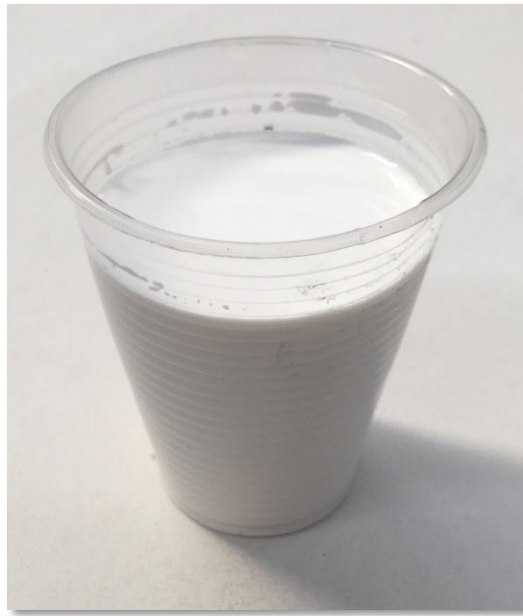
Şekil 3.6. Kopolimer dispersiyon esaslı polimer katkı malzemesi.
