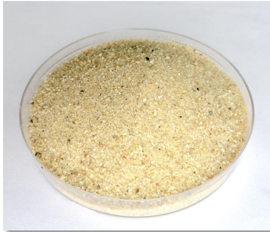
Şekil 3.5. Cam lif takviyeli numunelerde kullanılan silis kumu.
