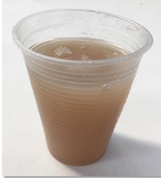
Şekil 3.7. Polikarboksilat esaslı süperakışkanlaştırıcı.
