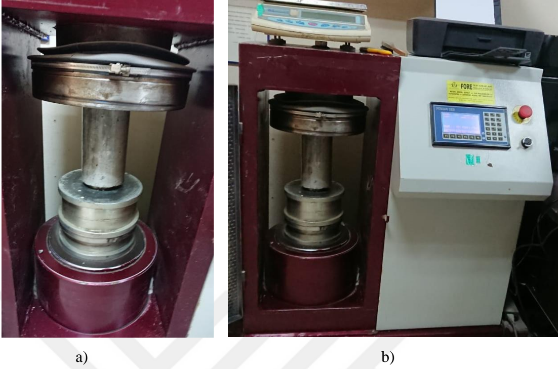
Şekil 2.7. a) ve b) Yükleme altındaki beton numune görselleri.
