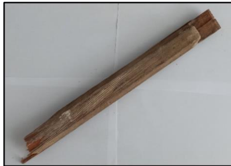
Şekil 3.4. 1799 numaralı yapıya ait A1 ahşap doğrama.
