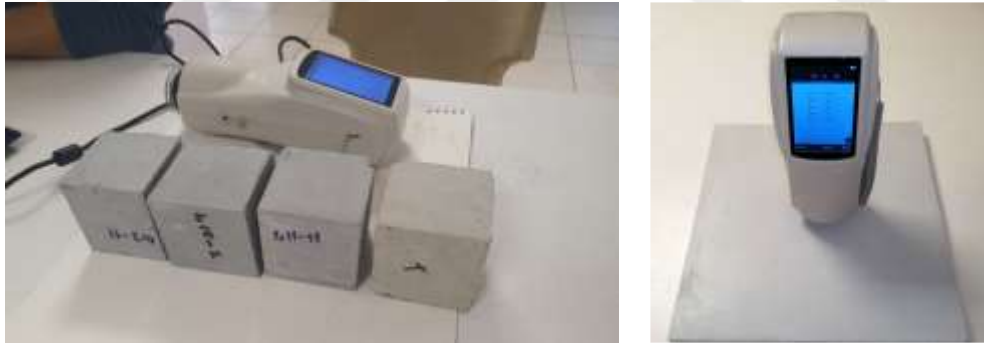
Şekil 3.29. Numuneler üzerinde renk ölçümlerinin yapılması
