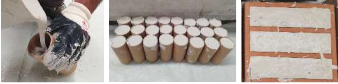
Şekil 3.14. UYPB kalıplara dökülmesi.
