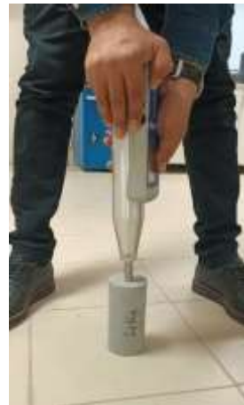
Şekil 3.21. Schmidt çekici ile yüzey sertlik tayini.
