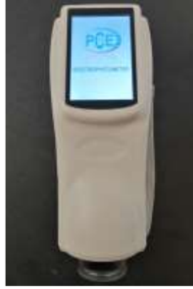
Şekil 3.28. Renk ölçüm cihazı
