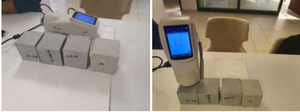
Şekil 4.19. Numuneler üzerinde renk ölçümlerinin yapılması.
