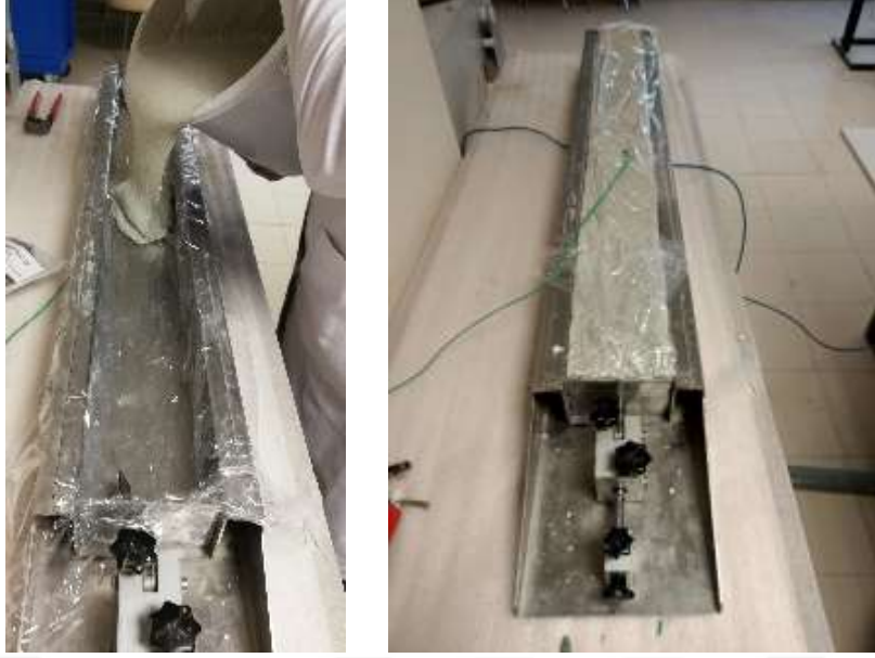
Şekil 3.19. Büzülme kalıbı ve deney düzeneği.
