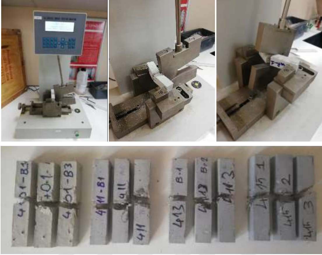
Şekil 3.24. UYPB darbe dayanımı tayini.
