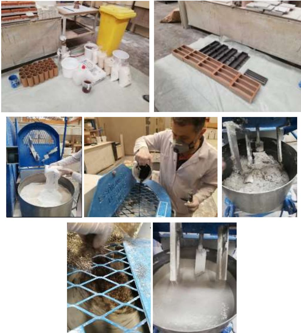
Şekil 3.13. UYPB betonların üretimi.
