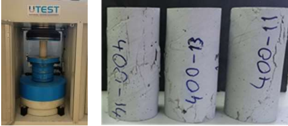
Şekil 3.22. UYPB basınç dayanımı tayini.
