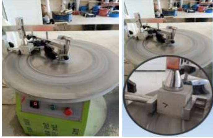
Şekil 3.25. Aşınma dayanımı tayini.
