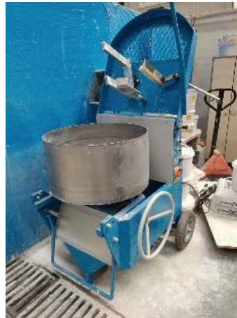
Şekil 3.12. Karışımlarda kullanılan 56 litre kapasiteli mikser.
