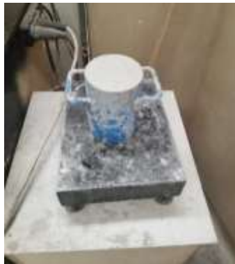
Şekil 3.18. Taze UYPB'nin yoğunluğunun belirlenmesi.
