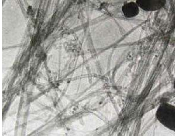
Şekil 2.29 TEM mikroskobunda SWCNT görüntüsü [289].
