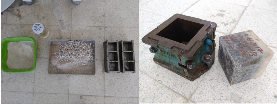
Şekil 2.2. Numune kalıpları ve karışıma giren malzemeler.
