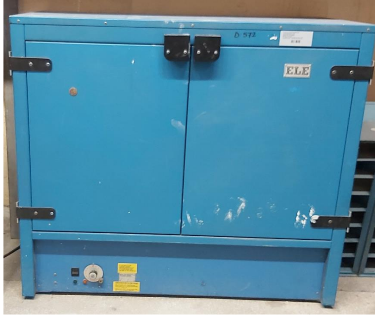
Şekil 2.3. Sıcaklık aktivasyonunun gerçekleştirdiği etüv.
