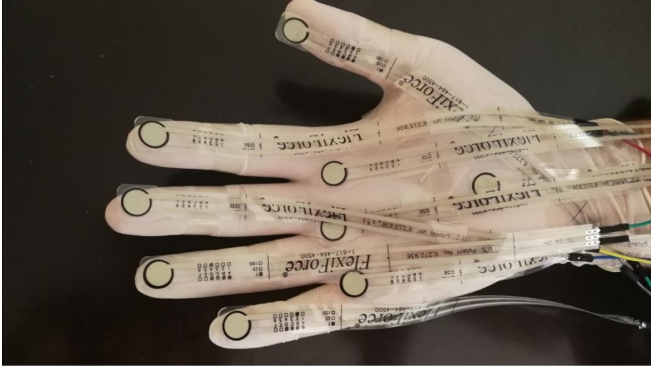
Şekil 4.2. Sensörlerin lateks eldiven üzerindeki yerleşimleri.
