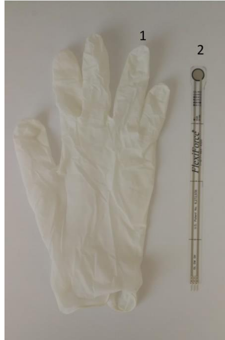
Şekil 4.1. Akıllı eldiven yapımında kullanılan malzemeler.
