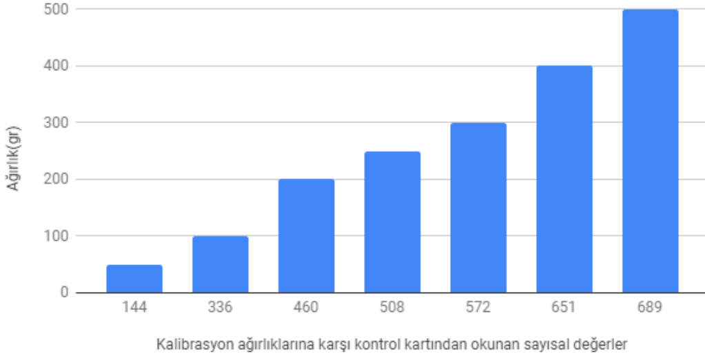
Şekil 2.2. 7 Farklı ağırlık ile yapılan ölçümlerde okunan sayısal veriler.
