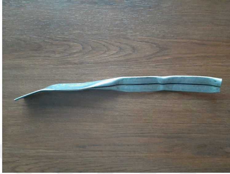
Şekil 6.3. Yassılma testi kabul gören numune.
