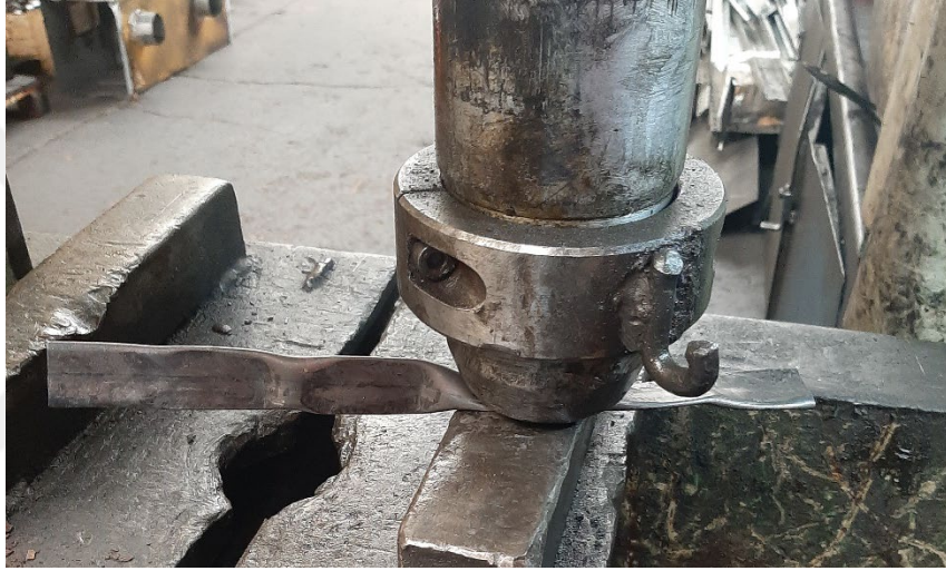
Şekil 6.2. Yassılma testi uygulanışı.
