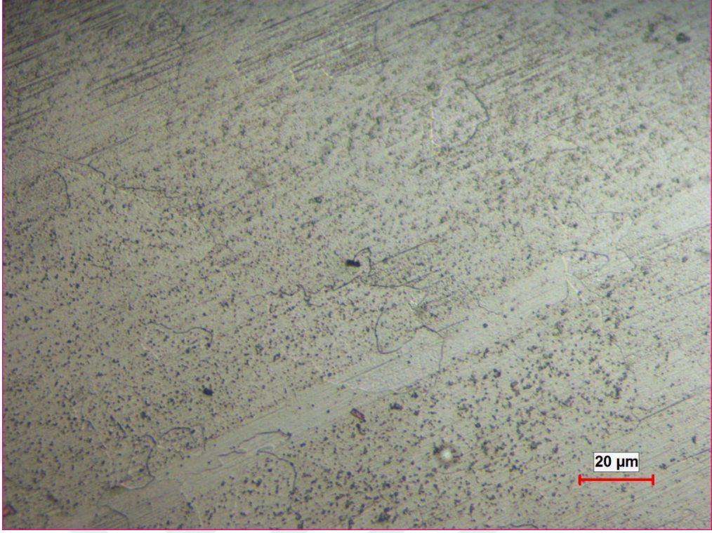
Şekil 6.68. 600°C tavlama sonrası 7114 tip numune kaynak dikişi mikroyapı görüntüsü.
