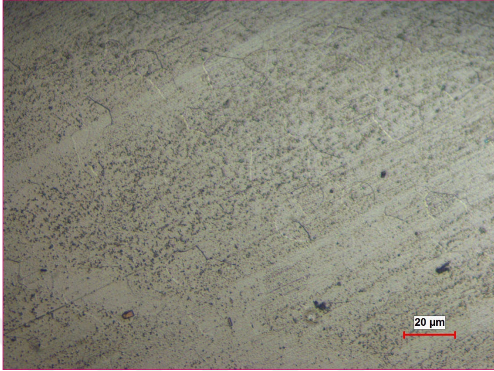
Şekil 6.74. 650°C tavlama sonrası 7114 tip numune ana metal mikroyapı görüntüsü.
