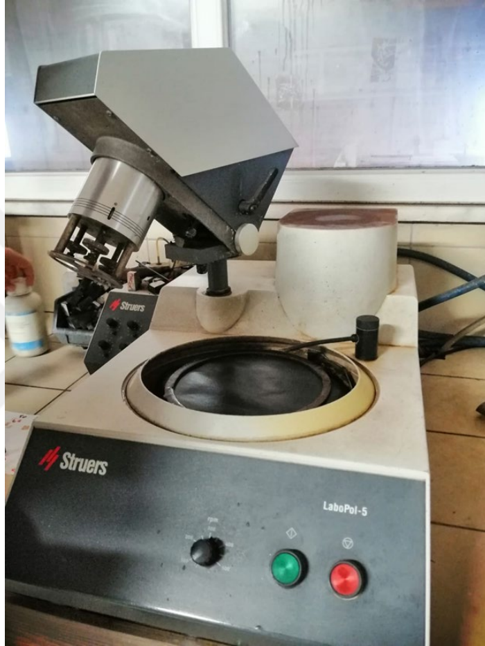
Şekil 6.24. Zımparalama ve parlatma yapılan makine.
