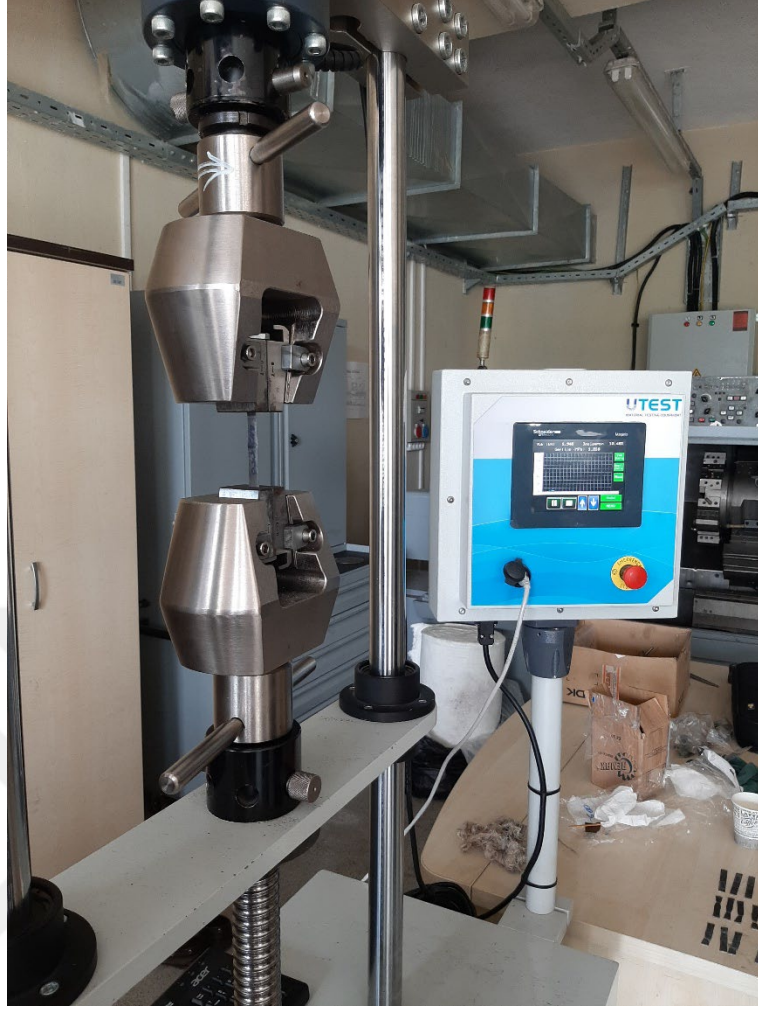
Şekil 5.4. Borudan alınan numunenin çekme testi.
