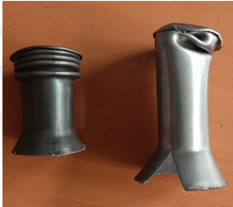
Őekil 6.4. 6112 tipi numunelere 550°C gerilim giderme tavlaması sonucu uygulanan geniřletme testi.
