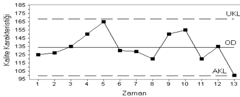
Şekil 7. Bir Ürünün Kalite Karakteristiğini Gösteren Kontrol Grafiği
