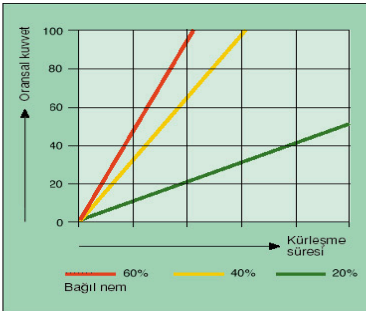
Şekil 9: Bağıl nemin bir fonksiyonu olarak siyanoakrilat yapıştırıcıların kürleşmesi (47).
