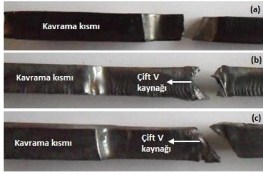
Şekil 7. Çekme numunelerinin kırılma formu, a) esas metal, b) bazik özlü tel, c) rutil özlü tel (Fracture form of tensile test samples, a) base metal, b) basic cored wire, c) rutile flux cored wire)
