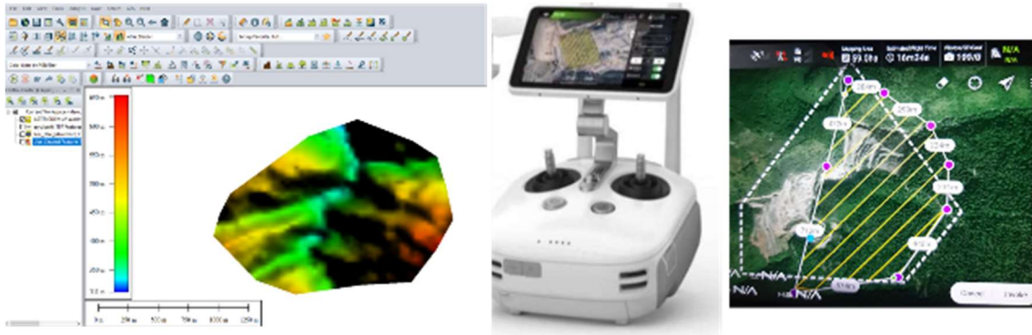
Şekil 2.5. SYM verisi elde edilmesi ve uçuş planının hazırlanması
