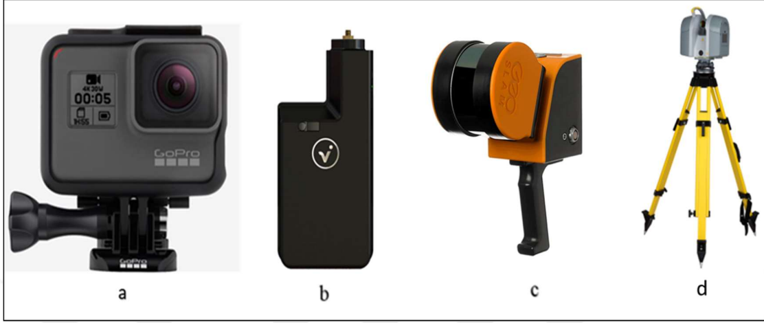
Şekil 1.3. Yersel fotogrametrik yöntemler: a) GPS entegreli kamera b) viDOC RTK tarayıcı c) El tip LIDAR tarayıcı d) Yersel lazer tarayıcı
