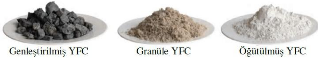
Şekil 2.3: Soğutma şekillerine göre yüksek fırın cürufu görüntüleri.
