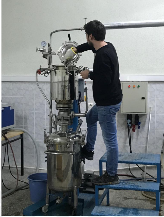
Şekil 3.2. Ayçiçeği sapslarına buhar patlatma cihazı ile hidro termal işlem uygulanması.
