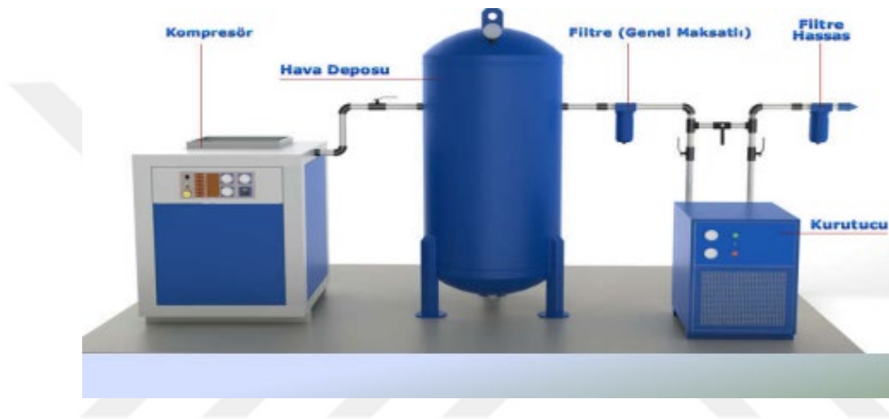
Şekil 2.3. Basınçlı Hava Üretim Tesisini [48].
