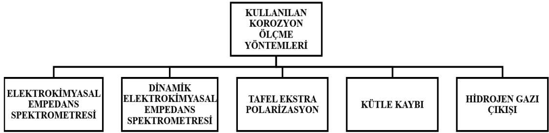
Şekil 2.2. Kullanılan korozyon ölçme yöntemleri.
