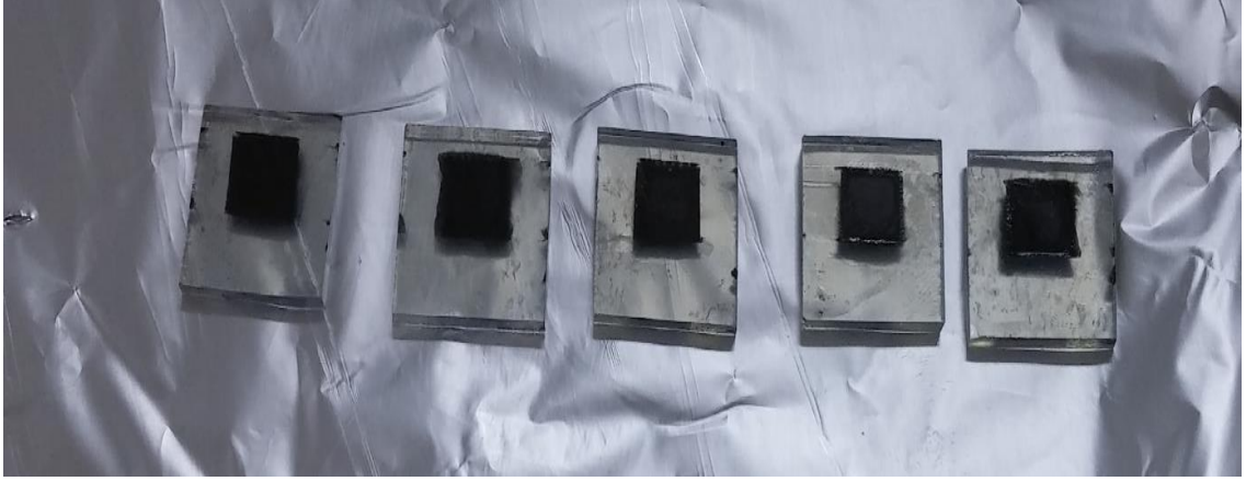
Şekil 2.20. 450°C’de sinterlenen FTO/Pt toplayıcı elektrotun son hali.
