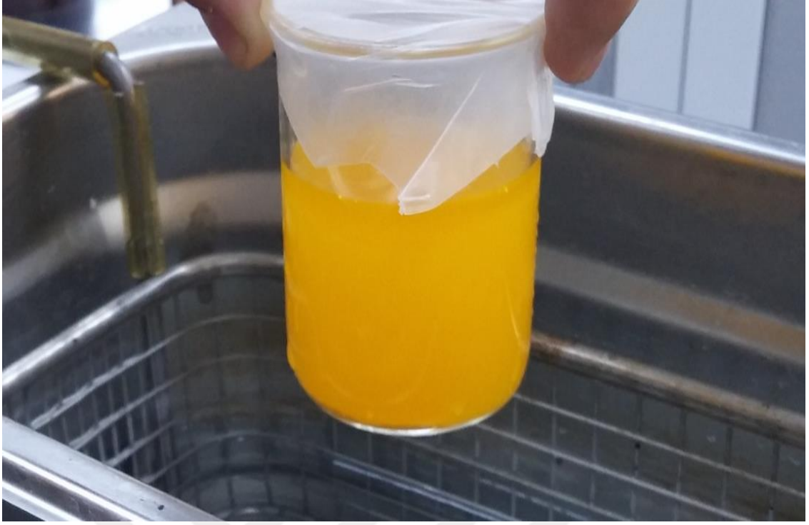
Şekil 2.18. Elektrokimyasal Pt kaplama metodu için hazırlanan (\text{NH}_4)_2\text{PtCl}_6 , \text{Na}_2\text{HPO}_4 \cdot 12\text{H}_2\text{O} çözeltisi.
