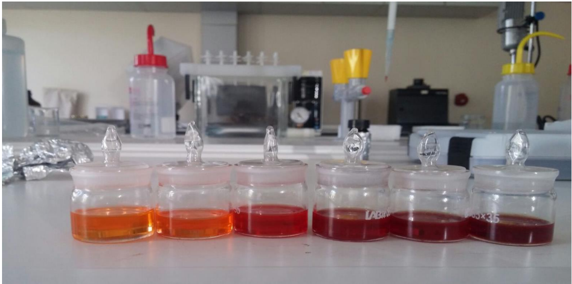
Şekil 2.15. TiO 2 yüzeyine CdTe KN'ların kaplanması için uygulanan DA metodunda kullanılan şilifli kaplar. Kap içerisinde kaplanması istenilen CdTe KN/tolüen solüsyonu ve TiO 2 kaplı yüzey yukarı bakacak şekilde yerleştirilmiş olan FTO/TiO 2 yüzey bulunmaktadır.
