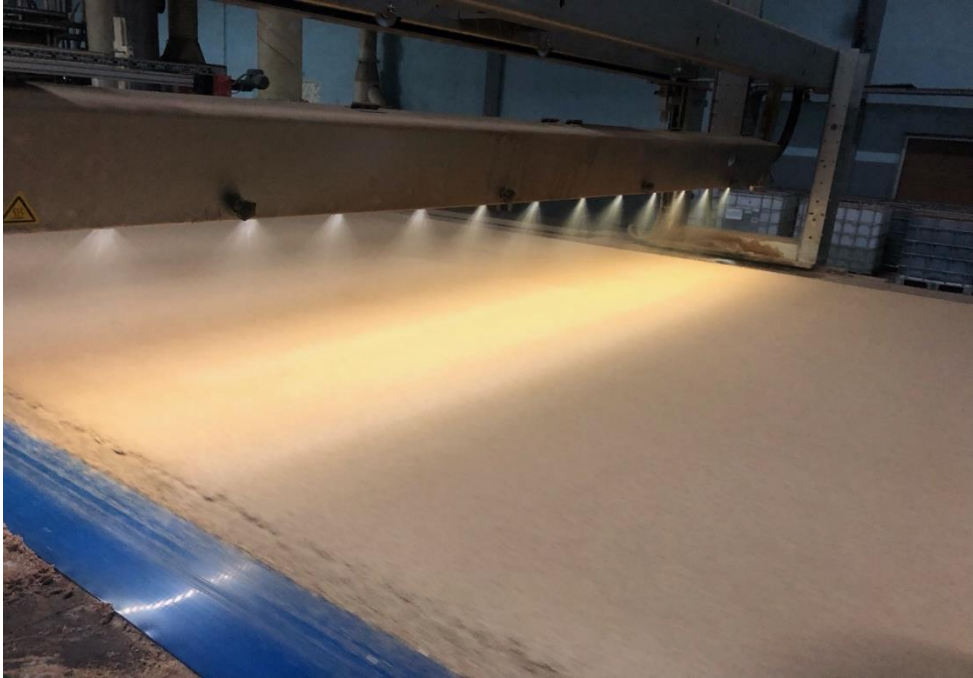
Şekil 2.2 Levha taslağı üzerine kalıp ayırıcı kimyasal püskürtme işlemi.
