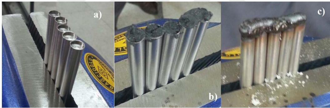
Şekil 5.7. Kaplama derinliklerinin resmi, a) Numuneler, b) Macun tozların boşluklara sıvanması, c) Kaynak işleminin uygulanması.
