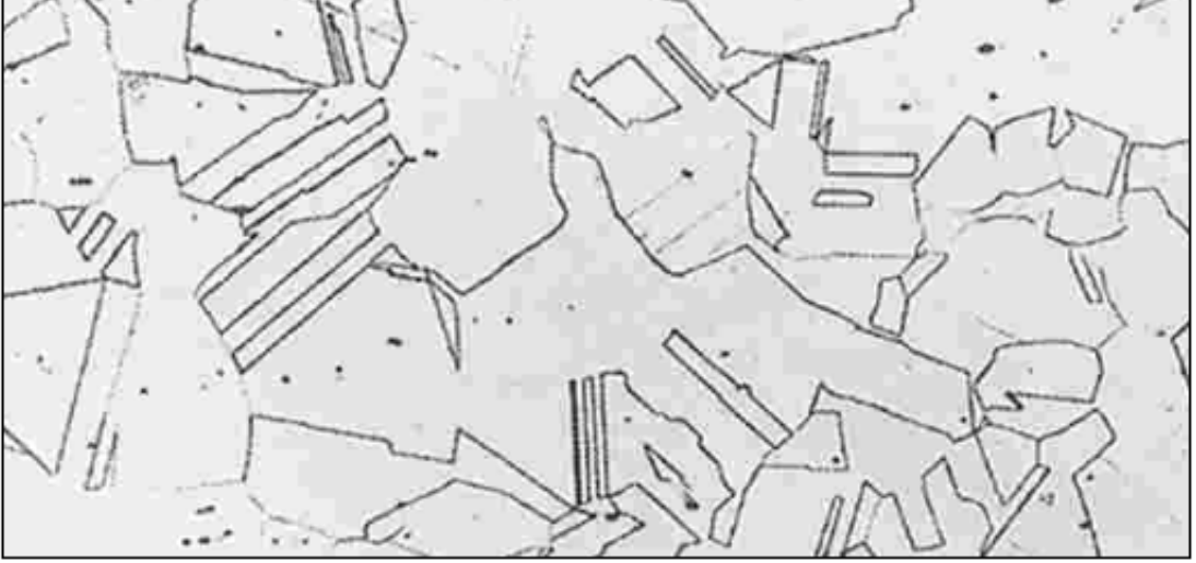
Şekil 3.3. Östenitik paslanmaz çelik mikro yapısı.
