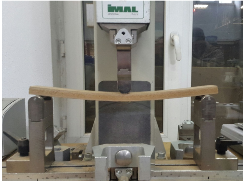
Şekil 2.4. Eğilme direnci testinin yapılışı.
