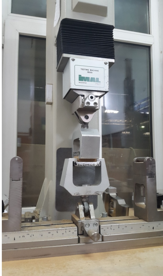
Şekil 2.5. Yüzeye dik çekme testinin yapılışı.
